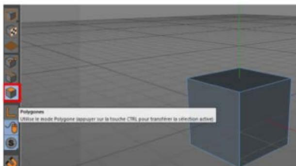
Ce mode va vous permettre de sélectionner un ou plusieurs polygones et d'appliquer des déformations sur ces derniers. Nous pouvons par exemple sélectionner un polygone sur le côté du cube et faire un clic droit/EXTRUSION.
