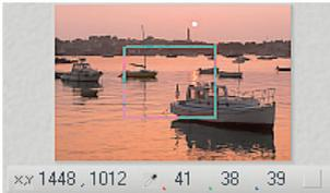
Les chiffres ci-contre décrivent les coordonnées XY de l'échantillonnage pipette ainsi que les valeurs R (41) V (38) et B (39) prélevées. Les valeurs RVB sont celles d'un espace échantillonné en 8 bits/couche et 256 niveaux !
