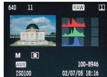
2. Cette deuxième photo a été surexposée de deux diaphragmes par rapport aux indications de la cellule. L'histogramme est décalé vers la droite sans pourtant frôler l'écrêtage des hautes lumières. L'aperçu révèle une image surexposée. Finalement, c'est celle-ci, « exposée à droite », qui malgré les apparences affiche le meilleur rapport signal/bruit. Les basses lumières sont encore suffisamment différenciées pour permettre une correction du gamma sans montée du bruit lors de la conversion RAW.
