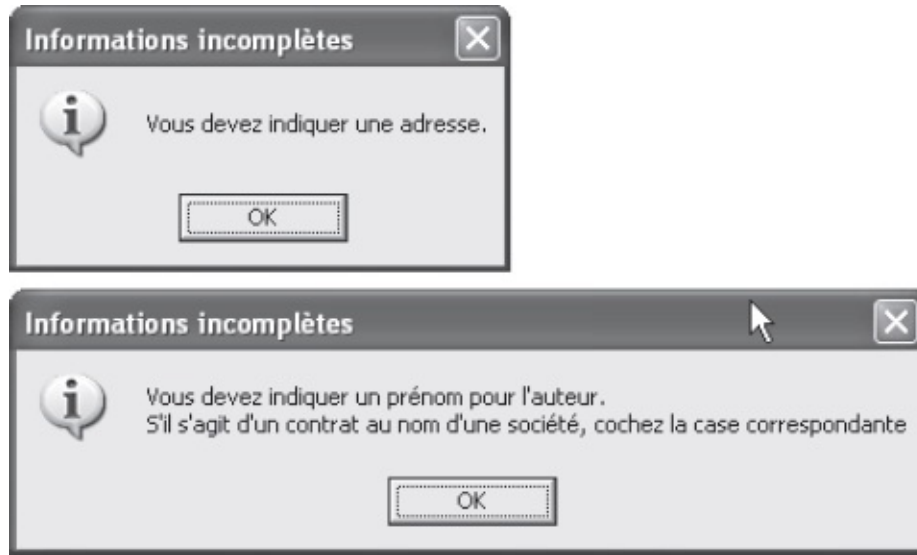
Figure 17-13 – Les données sont vérifiées avant d’être affectées aux variables.
