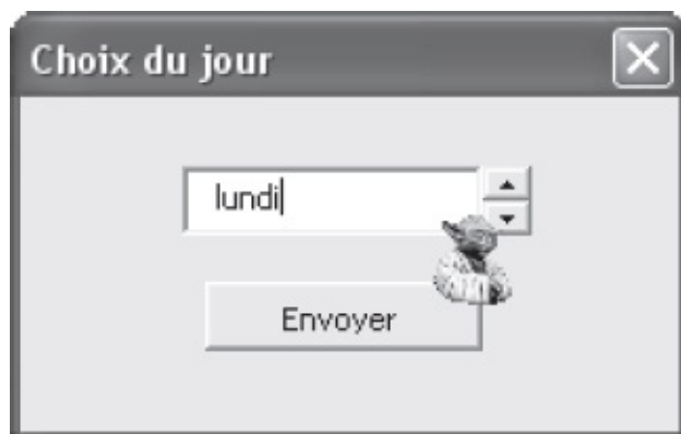
Figure 13-17 – La propriété MouseIcon affecte des icônes personnalisées aux contrôles.
