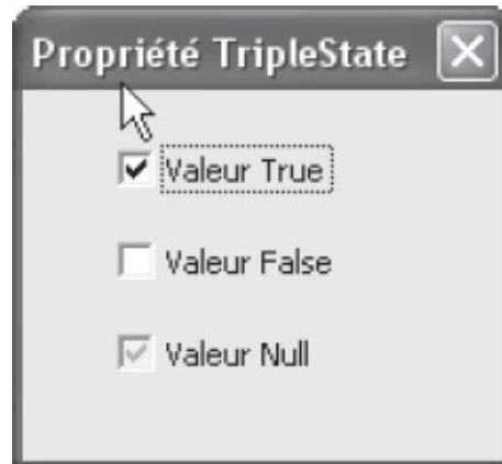
Figure 13-14 – Un contrôle CheckBox peut accepter trois états.
