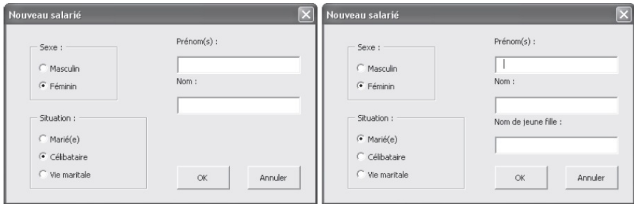
Figure 13-9 – La propriété Visible permet de déterminer les conditions d'apparition des contrôles pour l'utilisateur.
