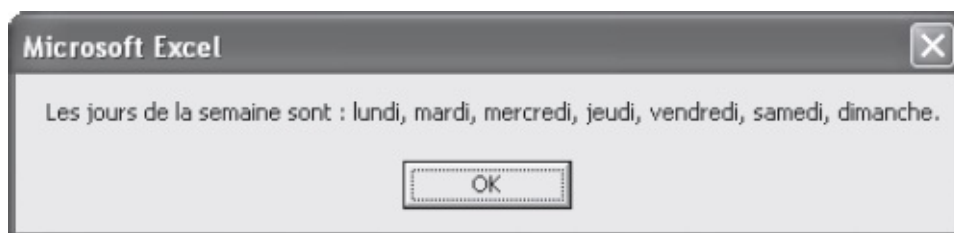
Figure 9-2 – Utilisez la fonction Join pour concaténer les espaces de stockage d'un tableau.
