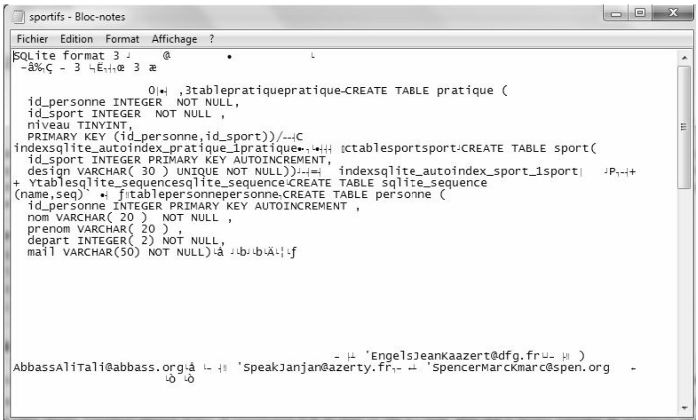
Figure 17-1 Structure d'un fichier de base SQLite
