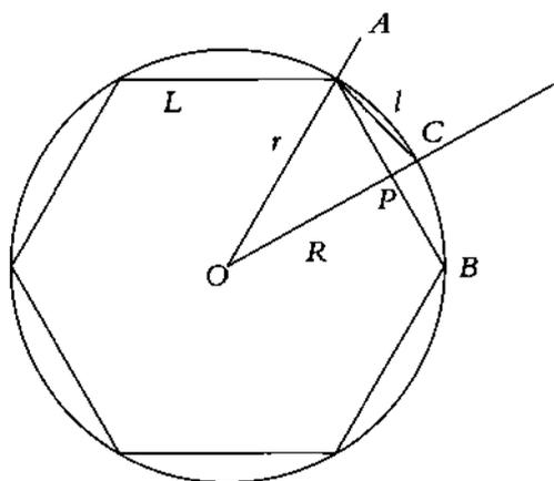
*Représentation du processus de calcul de la longueur  $l$  à partir de la longueur  $L$ ,  $L$  étant la longueur du côté d'un hexagone et  $l$  la longueur du côté d'un dodécagone.  $O$  représente le centre du cercle ;  $A$  et  $B$ , deux des sommets de l'hexagone ;  $C$ , le nouveau sommet, et  $P$ , le point du côté de l'hexagone qui est à la même distance de  $A$  et de  $B$ . La longueur du rayon est  $r$ , et la longueur du centre à  $P$  est  $R$ .*
