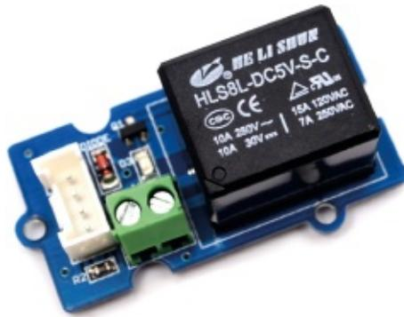
Repartons du montage de l'étape 1, enrichi donc d'un second microrupteur, et branchons le relais sur le port OUT 1 du TI-Innovator™ Hub. Il suffit alors d'expliquer au Hub qu'un dispositif de type relais est branché sur ce port. Pour activer le relais, il faudra envoyer la commande **Send(«SET RELAY 1 TO 1»)**, et pour le désactiver la commande **Send(«SET RELAY 1 TO 0»)**, la diode s'allumant et s'éteignant conjointement.
