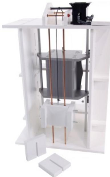
On notera la forme astucieuse de l'ergot positionné sur la cabine d'ascenseur. Il permet d'enclencher en douceur et efficacement les microrupteurs de début (Rdc) et de fin (Étage 1) de course.
