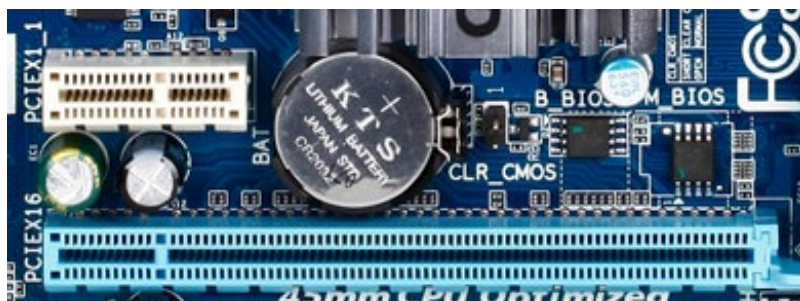
En haut (en blanc) : un port PCIe 2.0 x1. En bas (en
