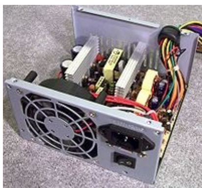
Intérieur d'un bloc d'alimentation
