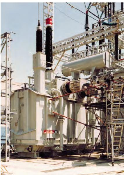
Transformateur élévateur 360 MVA-400kV essai de court-circuit
