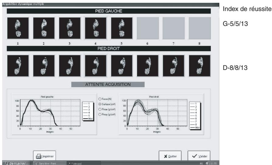
Marche chaussée, profils de courbes différents, mais moins d'essais nécessaires à gauche pour obtenir d'emblée une courbe homogène
