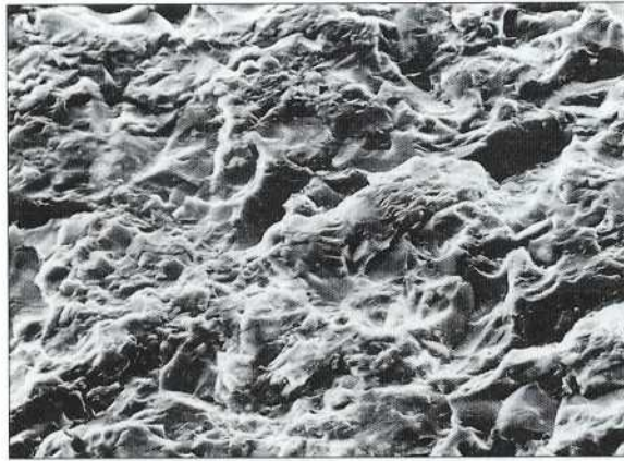
14.11 Multitude de fractures cassantes sur une facette d'usure en céramique (photographie par microscope électronique à balayage).
