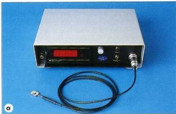
8.3 a Lecteur de force de morsure miniature pour la mesure des forces locales. b On notera l'augmentation limitée de la dimension verticale d'occlusion.
