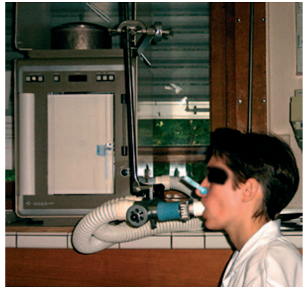
Figure 2. Spiromètre à cloche. Le patient ventile par la bouche en portant un pince-nez. Le déplacement de la cloche est proportionnel au volume pulmonaire mobilisé.
