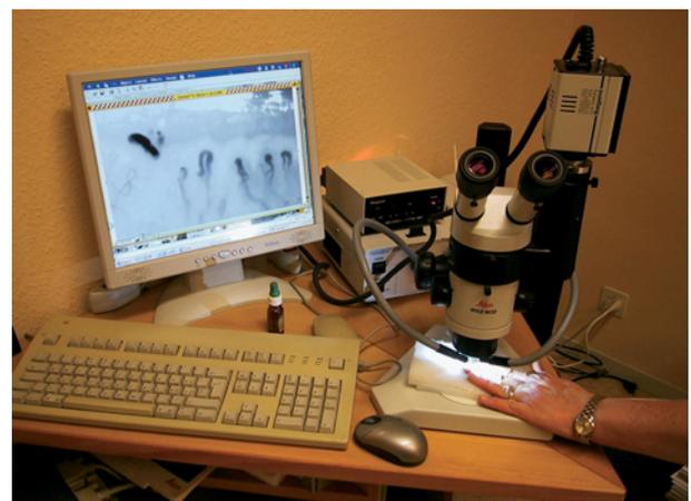
Fig. 6-21 – **Capillaroscopie.** Microscope binoculaire grossissant 16 à 40 fois couplé à une caméra vidéo et à un ordinateur permettant un traitement et un archivage des photographies d'examen.
