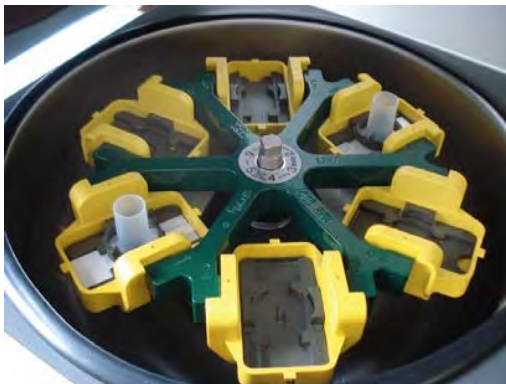
Fig. 3-54 Centrifugeuse Hettich Universal 16A® (cytopspot).
