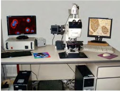
Fig. 3-3 Microscope à fluorescence équipé d'une caméra reliée à deux écrans via un ordinateur.
