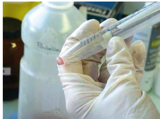
Fig. 3-52 Récupération du culot de centrifugation à l'aide d'une pipette automatique.
