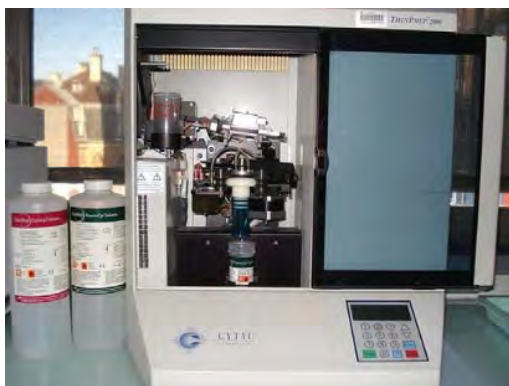
Fig. 3-56 Préparateur automatique à chargement individuel ThinPrep® 2000 (Cytoc).
