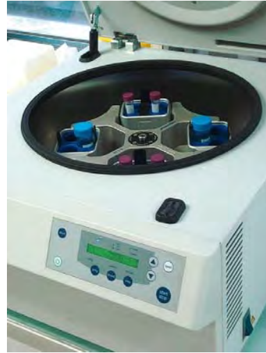
Fig. 3-51 Centrifugeuse Eppendorf Centrifuge 5810®.
