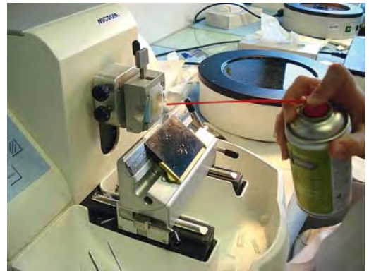
Fig. 3-35 Refroidissement de la surface du bloc avec un aérosol de congélation.
