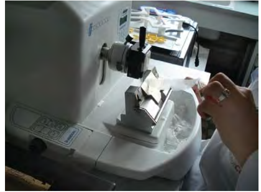
Fig. 3-34 Réalisation d'un ruban au microtome.
