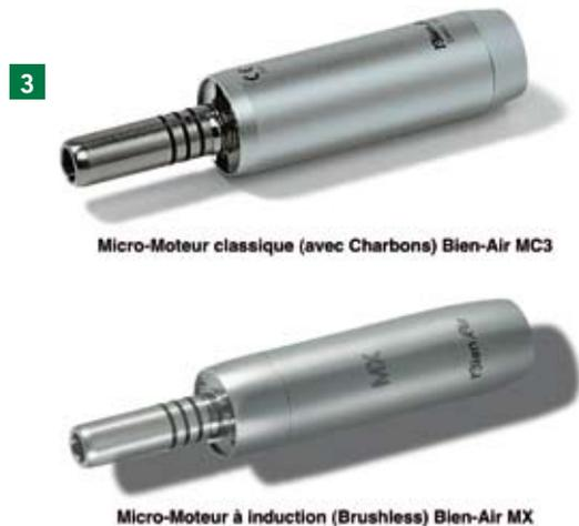
Extérieurement, il n'y a quasiment pas de différence entre les micro-moteurs des 2 familles. Avec la technologie « brushless », les rôles ont été inversés, le rotor ne comporte plus de bobinage mais un aimant permanent. Le Stator n'est plus un aimant, mais un bobinage électrique fixe (Fig. 3 et 4).
