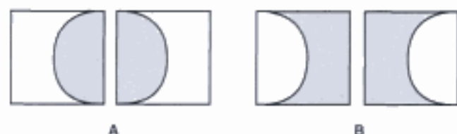
Fig. 11-18. Réfraction d'un dioptré sphérique. Dessinez un rectangle autour de la surface courbe, et déterminez la « forme » du milieu d'indice de réfraction le plus élevé. Si la « forme » de la lentille constituée par le milieu d'indice de réfraction le plus élevé est plan-convexe (A), le dioptré sphérique a une puissance positive. Inversement, si la « forme » de la lentille constituée par le milieu d'indice de réfraction le plus élevé est plan-concave (B), le dioptré sphérique a une puissance négative.
