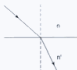
Fig. 11-2. Lorsque le rayon lumineux se propage d'un milieu d'indice de réfraction plus faible vers un milieu d'indice plus élevé, le rayon réfracté se rapproche de la normale.
