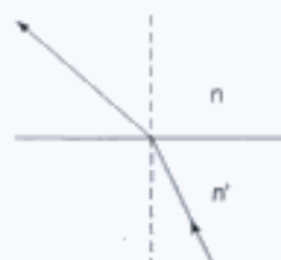
Fig. 11-3. Lorsque le rayon lumineux se propage d'un milieu d'indice de réfraction plus élevé vers un milieu d'indice plus faible, le rayon réfracté s'écarte de la normale.
