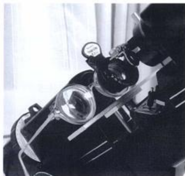
Fig. 14-5. Après avoir réalisé une surréfraction à l'aide de verres de test amovibles, la combinaison doit être soigneusement placée dans un frontofocomètre, où la combinaison résultante est lue.
