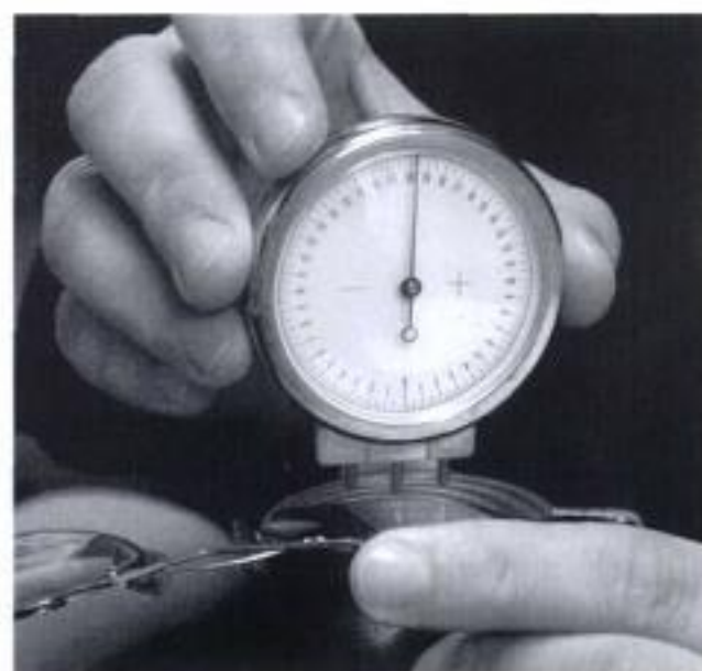
Fig. 14-9. Une montre de lentille de Genève est utilisée pour mesurer la courbure de la surface avant d'un verre de lunettes.
