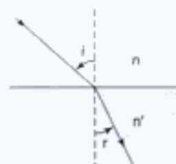
Fig. 11-4. Le rayon incident, la normale et le rayon réfracté sont situés dans un même plan. i est l'angle formé par le rayon incident et la normale, et r l'angle formé par le rayon réfracté et la normale.
