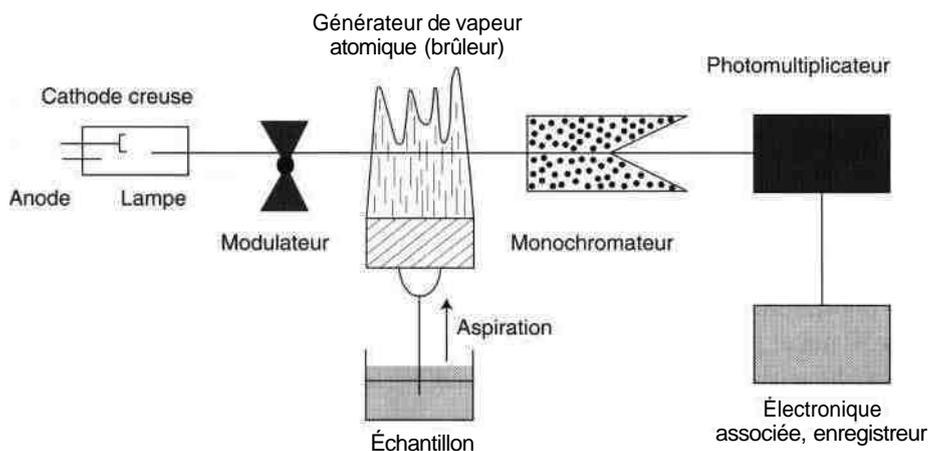
Figure 3.13 • Schéma de principe d'un spectrophotomètre d'absorption atomique.
