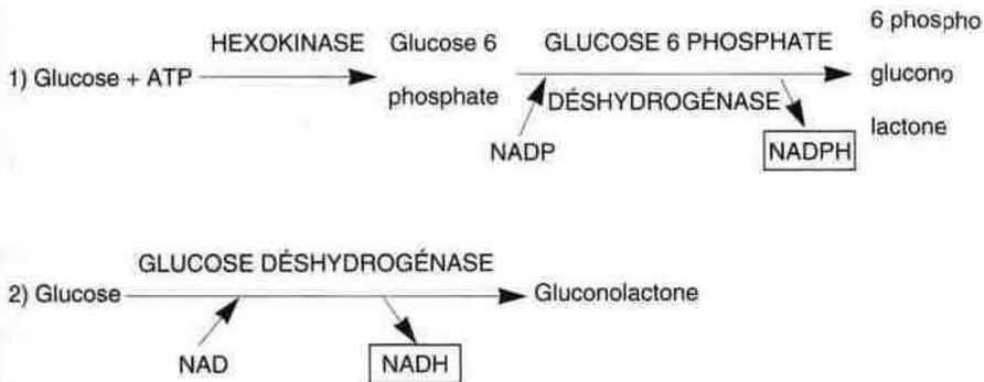
Figure 6.5 • Schéma réactionnel avec lecture à 340 nm.
