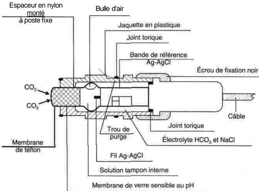
Figure 2.10 • Electrode de mesure de la  $p\text{CO}_2$ .
