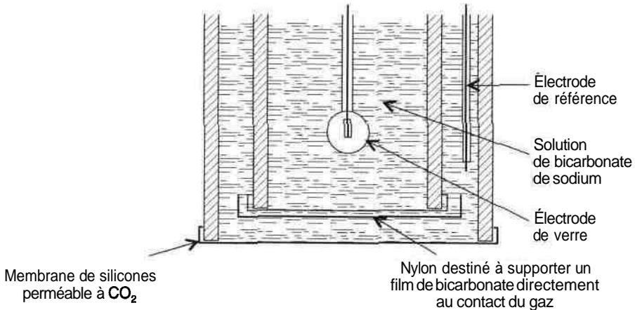
Figure 1.8 • Schéma d'une électrode de  $\text{pCO}_2$ .
