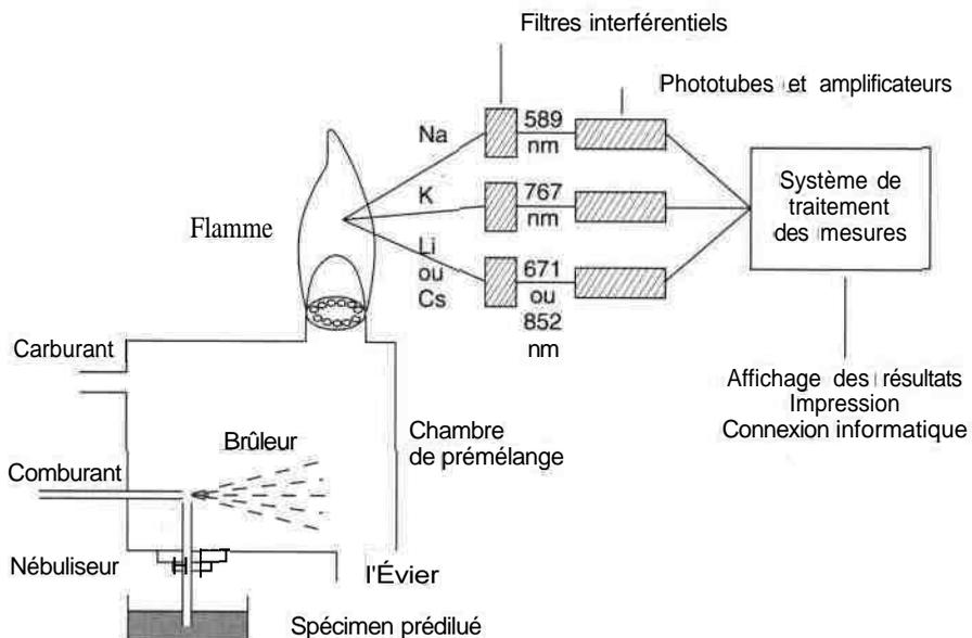
Figure 1.6 • Schéma de principe d'un photomètre de flamme.
