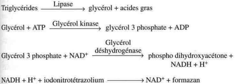
La lecture colorimétrique est effectuée à 500 nm. La coloration due au Formazan est proportionnelle à la concentration en triglycérides dans le sérum. Cette première technique enzymatique colorimétrique est en voie d'abandon.
