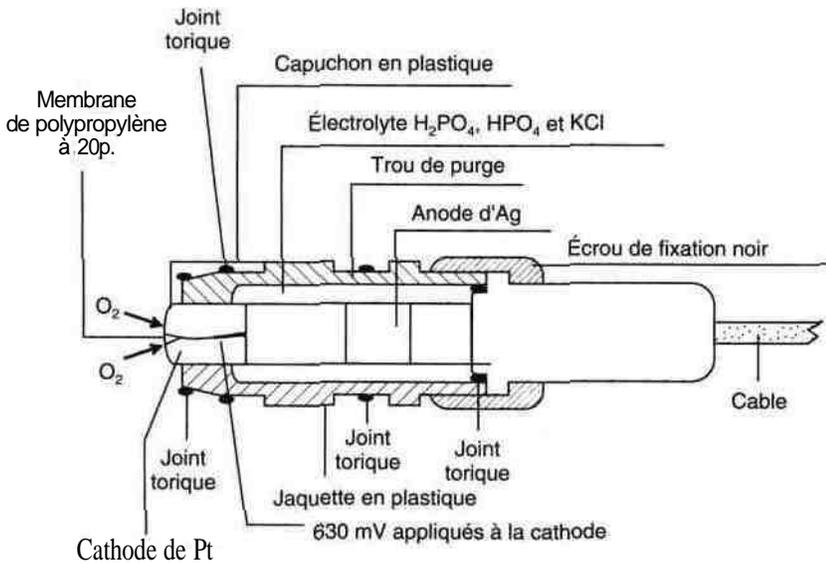
Figure 2.8 • Électrode de mesure de la pO<sub>2</sub>.
