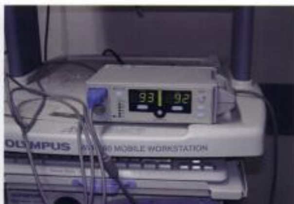
Photo 5.3 Saturomètre pour la mesure en continue de la SpO_2 (surveille également le pouls).
