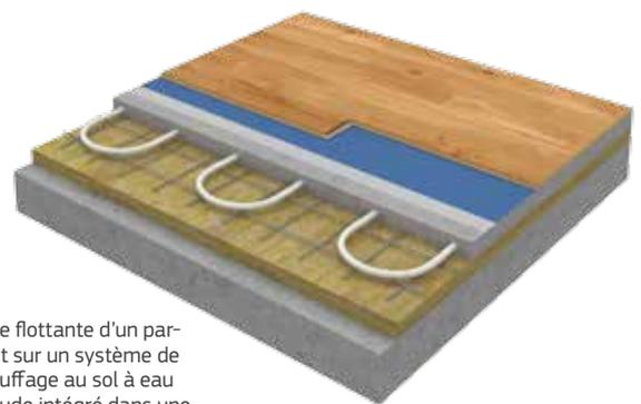
Pose flottante d'un parquet sur un système de chauffage au sol à eau chaude intégré dans une chape flottante
