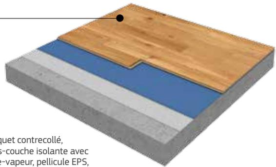
Parquet contrecollé, sous-couche isolante avec pare-vapeur, pellicule EPS, béton
