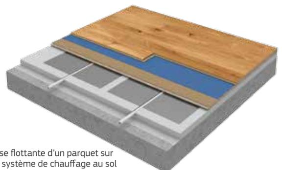
Pose flottante d'un parquet sur un système de chauffage au sol avec câbles chauffants dans des plaques conductrices de chaleur
