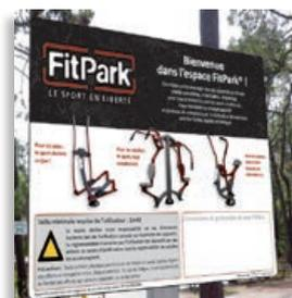
Panneau d'affichage en aluminium de 700 x 500 x 2 mm à bord plié, angles arrondis, 2 rails de fixation de 500mm, fond vinyle blanc, impression numérique thermique en quadrichromie, laminage (film protection anti-UV). Poteau en acier galvanisé 80 x 40mm avec obturateur, 2,5m de hauteur. Livré avec bride en acier galvanisé de 80 x 40mm, avec boulonnerie.
