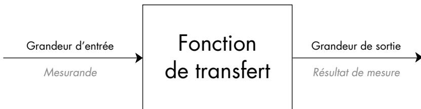
La mesure n'est qu'une interprétation subjective de la réalité (mesurande). Pour être conscient de cette subjectivité (et éventuellement être capable d'esprit critique), il est souhaitable d'avoir une vue de l'ensemble des composants de la chaîne de mesure. Cette dernière peut être illustrée par les composants suivants (fig. 2.5).
