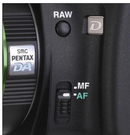
**Figure 3.7** : Le commutateur de mise au point manuelle (MF, Manual Focusing) ou automatique (MA, Automatic Focusing).
