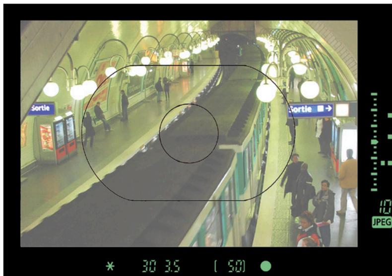
**Figure 6.5 :** Les repères de la mesure spot (cercle au centre du viseur) et de la mesure à prépondérance centrale (ovale).
