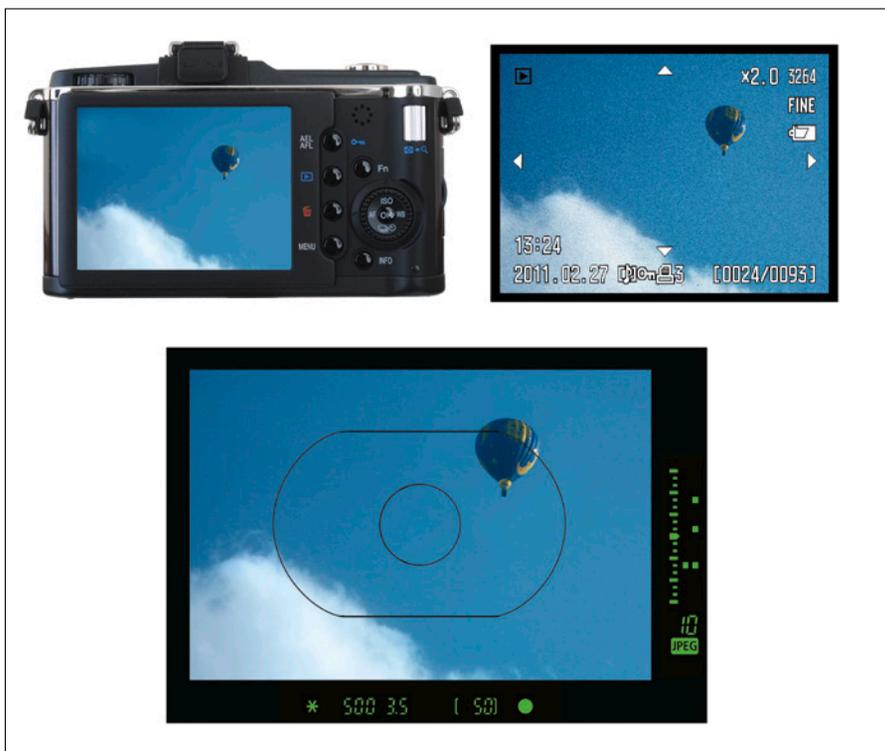
**Figure 1.2 :** Un écran ACL externe (en haut à gauche), un viseur électronique (en haut à droite) et une visée reflex (en bas).
