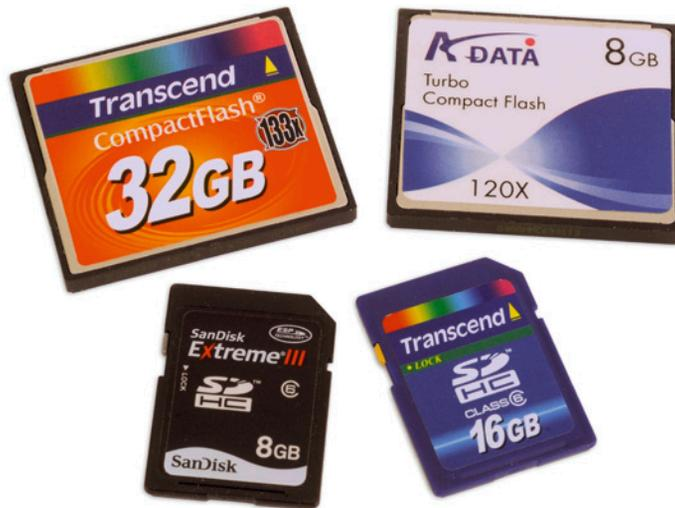
Figure 2.12 : Deux cartes mémoire CompactFlash (en haut) et deux cartes SDHC (en bas).
