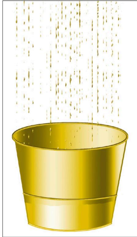
Figure 2.5 : Un photosite est formé d'un puits qui recueille les photons.
