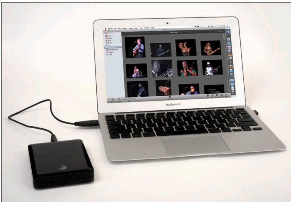
**Figure 4.3 :** En voyage, un disque dur externe compact alimenté par le port USB est une solution commode.
