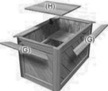
Coupez des planches de 1 po x 6 po et fixez-les (ou déposez les simplement sans les fixer) perpendiculairement aux baguettes de façon à fermer le faux fond (H).
