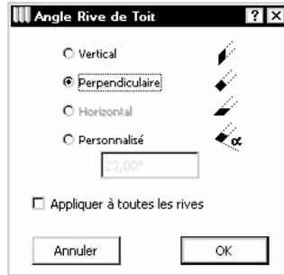
**Figure 13.13** - Les options d'angle de rive de toit
