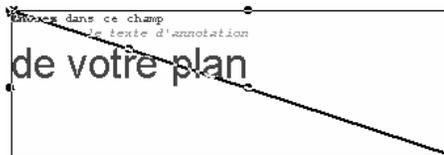
Figure 29.10 - Bloc de texte pendant la modification (étirement) angle bloqué (alt a ou touche majuscule)
