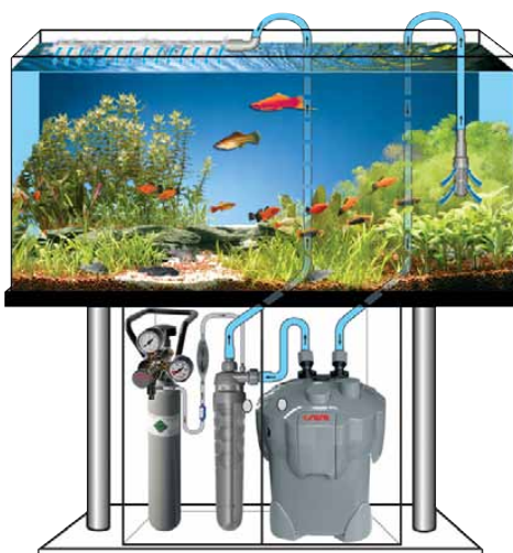
Intégration dans le circuit de filtration
