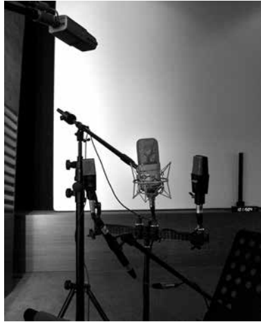
Figure 5.110 – Dispositif de captation voix narrative, « La personne aux deux personnes », C M149, L et R AKG C414, arrière Sony C48 et Lfe AKG C460, © Thierry Lebon.
