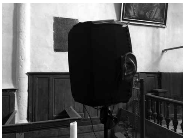
Figures 5.106, 5.107, 5.108 – Configuration binaurale de Bernard Lagnel, couple binaural avec oreilles artificielles, ce système est ici complété par un couple XY utilisé pour la précision des plans proches et pour la compatibilité 5.1 (système « plug and rec studio »), © B. Lagnel. La deuxième photo représente le système avec des DPA 4060 et le zoom H4n utilisé pour le reportage et les ambiances. La troisième photo représente « le cyclope » ou « Headgar », une enceinte Genelec 8020 B équipée d'oreilles artificielles, © B. Périaux.
