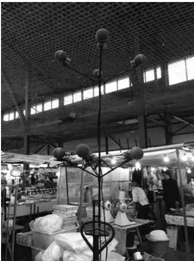
Figure 5.33 – Exemple d'une configuration MMAD 3D 9.0 cardioides pour la couche horizontale, bidirectionnels pour la couche élévation, le marché © B. Périaux.
