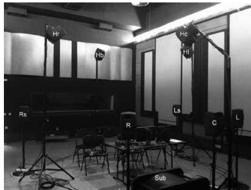
Figure 1.24 et 1.25 – Formats 7.1 75/120, 9.1, 11.1 préconisés par Mike Williams, photo d'une disposition 9.1 à l'INA, © B. Périaux.
