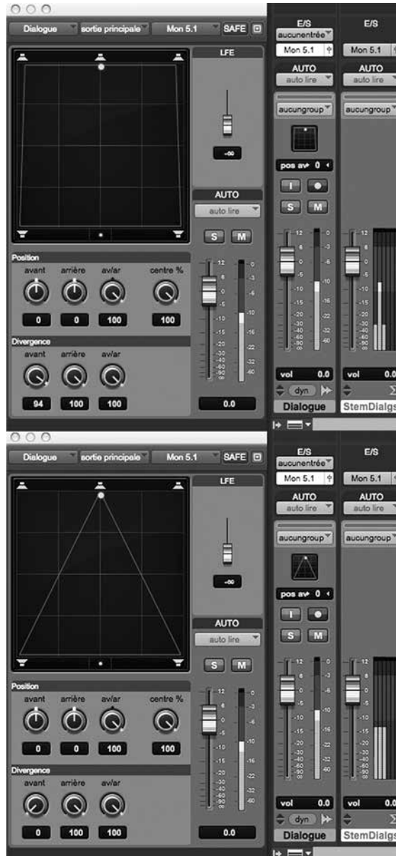
Figure 6.27 – Resserrement de l'espace frontal par Divergence dans Pro tools, © Avid.
