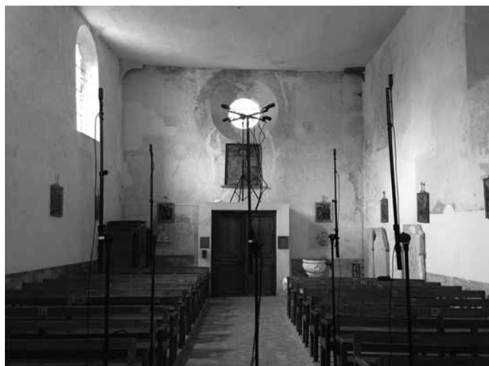
Figure 5.84 – Croix IRT et Carré Hamasaki en église, © B. Périaux.
