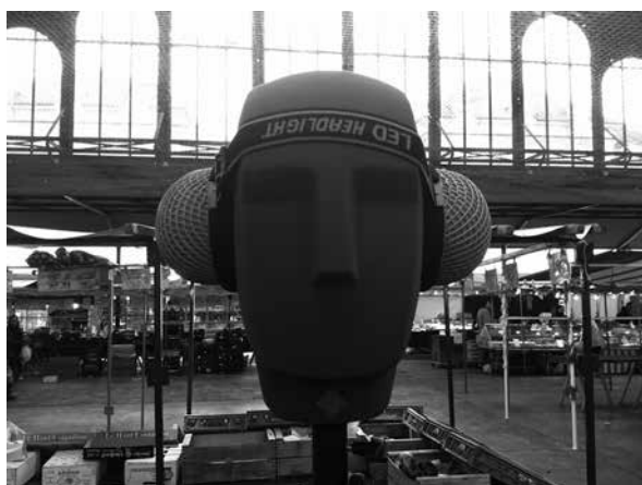
Figure 5.102 – Tête artificielle Neumann KU100, © B. Périaux.
