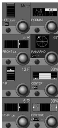
Figure 6.17 – Pan-pot type Studer Vista 9 « Multi-format Pan », © Studer
