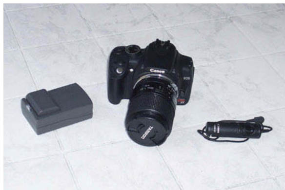
Boîtier Canon 350D et quelques accessoires (à gauche : chargeur de piles ; à droite : déclencheur souple) (Photo E. Beaudoin).
