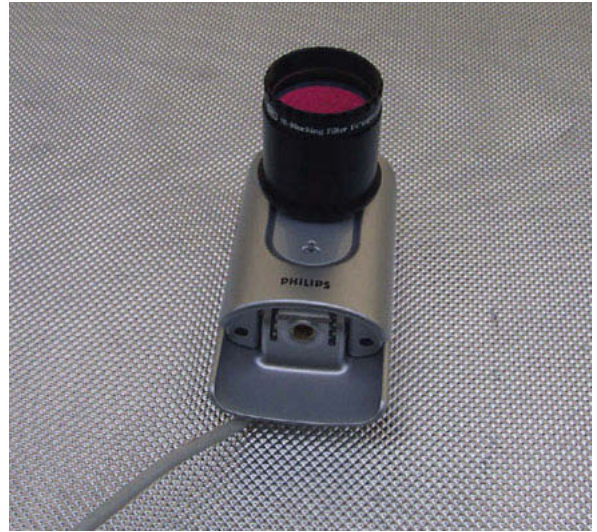
Filtre IR-cut monté sur l'adaptateur d'une webcam (Photo E. Beaudoin).
