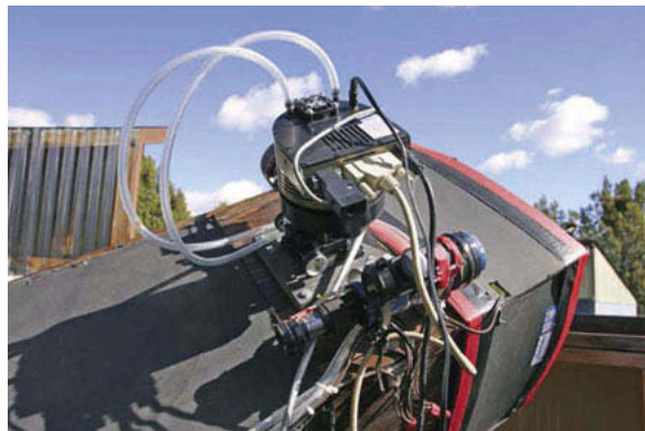
Caméra CCD montée sur un télescope Newton de fabrication personnelle. La présence de câbles électriques et ici de tuyaux de refroidissement exige certaines précautions de manipulation (Photo C. Schur).
