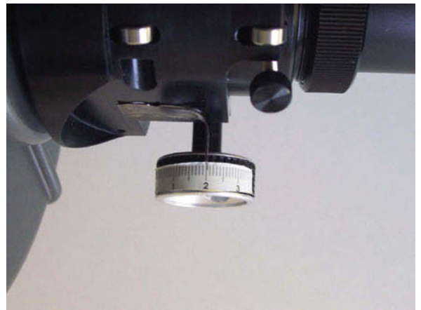
Graduation millimétrée et repère métallique collés sur une crémaillère de type Crayford. Grâce à la démultiplication, la précision sur la mise au point est d'environ 0,05 mm (Photo E. Beaudoin).
