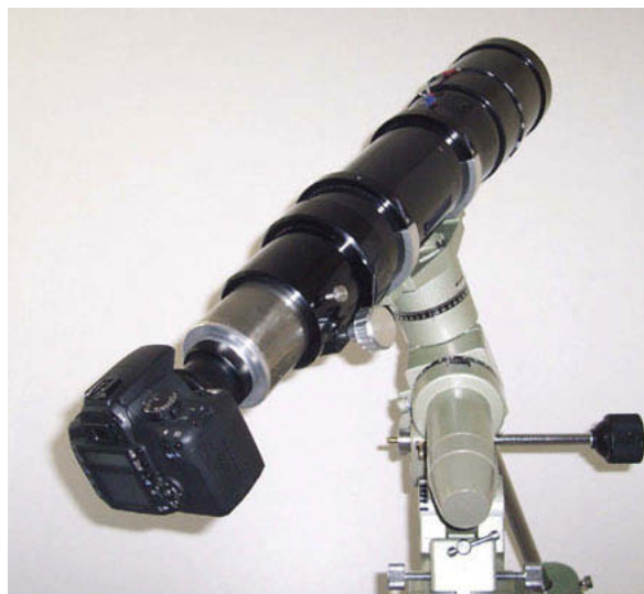
Lunette apochromatique sur laquelle est installé un boîtier numérique (Photo E. Beaudoin).
