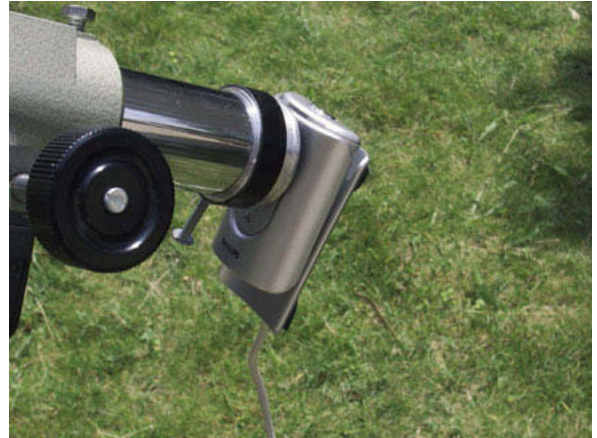
Webcam Philips ToUcam Pro II montée sur une crémaillère au coulant 31,75 mm (Photo E. Beaudoin).
