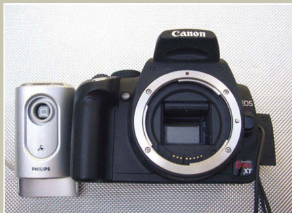
Aperçu des capteurs d'une webcam (2,8 mm × 3,7 mm) et d'un APN (15 mm × 22 mm) (Photo E. Beaudoin).
