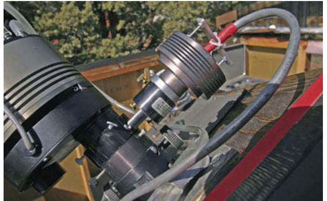
Système de guidage par diviseur optique, avec oculaire réticulé éclairé (à gauche) et avec caméra CCD (à droite) (Photos E. Beaudoin et C. Schur).
