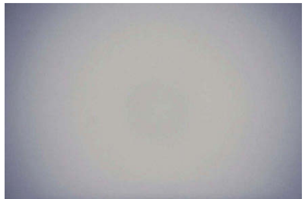
PLU réalisée sur le ciel au foyer d'un télescope Schmidt-Cassegrain de 355 mm avec réducteur de focale 0,63x. Le phénomène de vignettage apparaît nettement (Photo E. Beaudoin).
