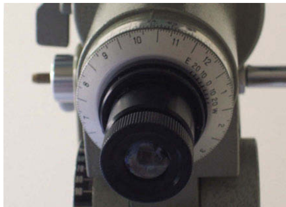
Viseur polaire avec cercles gradués permettant son orientation en fonction de la date (Photo E. Beaudoin).
