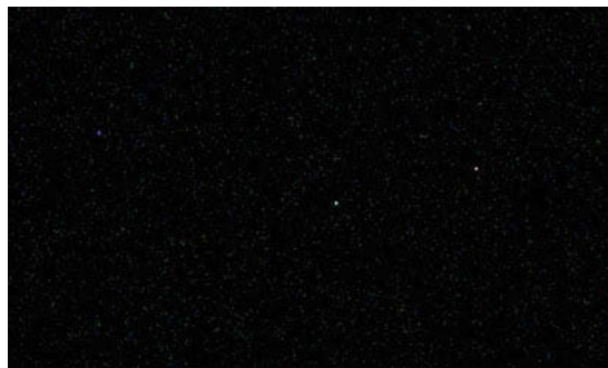
Signal thermique d'un boîtier Canon 350D sur une image prise dans le noir complet (signal d'obscurité). Même sensibilité (800 ISO) et même température (20 °C). (Photos E. Beaudoin.) À gauche : 30 s de pose : seuls quelques « pixels chauds » apparaissent. À droite : 10 min de pose : le signal thermique devient visible.
