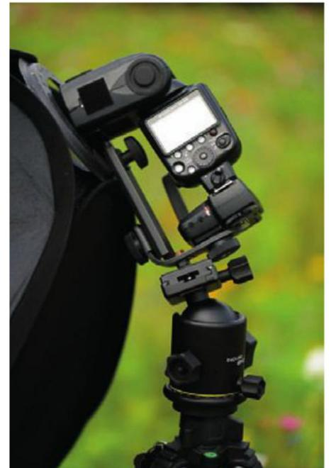
*Au dos de la boîte à lumière, le système de fixation pour flash, ici monté avec un récepteur radio PocketWizard.*
