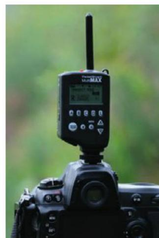
*Dispositif radio fabriqué par PocketWizard. Cette marque propose différents types de récepteurs et d'émetteurs. Le Flex TT5 peut faire les deux !*
