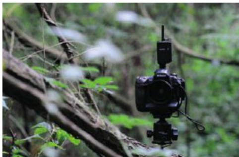
*Une vis spéciale photo a été fixée sur une branche pour y installer la rotule et le boîtier équipé d'un système de déclenchement PocketWizard Multimax. Vérifiez bien tous les réglages (exposition, mise au point) mais aussi la batterie et les cartes !*
