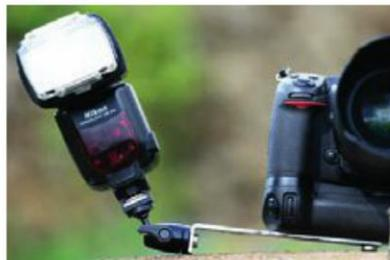
*Une petite plaque de métal percée aux deux bouts permet de tenir le flash en extension tout en le maintenant relié au boîtier. Il suffit de percer la baguette au diamètre des vis ¼.*
