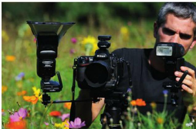
*Barrette Manfrotto permettant de supporter un boîtier et deux flashes. Vendu par Jama, ce système permet de se déplacer facilement autour du sujet. Ce modèle est très utile sur le terrain. Attention à bien serrer les bras, si les flashes sont lourds, pour éviter qu'ils ne basculent.*
