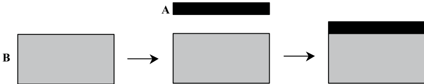
FIG. 3.16 – Processus thermodynamique de formation puis d’adhésion d’une couche 2D sur un substrat étranger.
