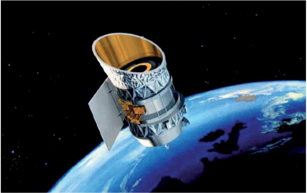
**Figure 2.1.** Le satellite infrarouge IRAS (*InfraRed Astronomical Satellite*). Lancé en 1983, il a réalisé, depuis l'orbite terrestre, un sondage profond du ciel à quatre longueurs d'onde de l'infrarouge moyen et lointain (12, 25, 60 et 100 microns) (©NASA/NIVR/SERC).
