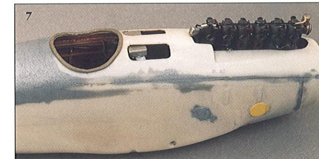
5-6. Avec un mastic à deux composants, on réalise le bord en cuir du poste de pilotage.
