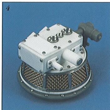
4-5. Avec du plastique de 0,3 mm, un morceau de grille en laiton et une feuille d'étain, on améliore le carter et l'entrée d'air du compresseur.
