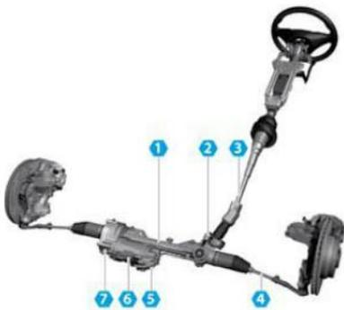
**Figure 19.22** Direction assistée électrique.
