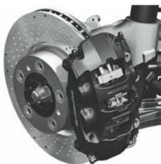
Figure 10.7 Freins à étrier fixe à 4 pistons.
