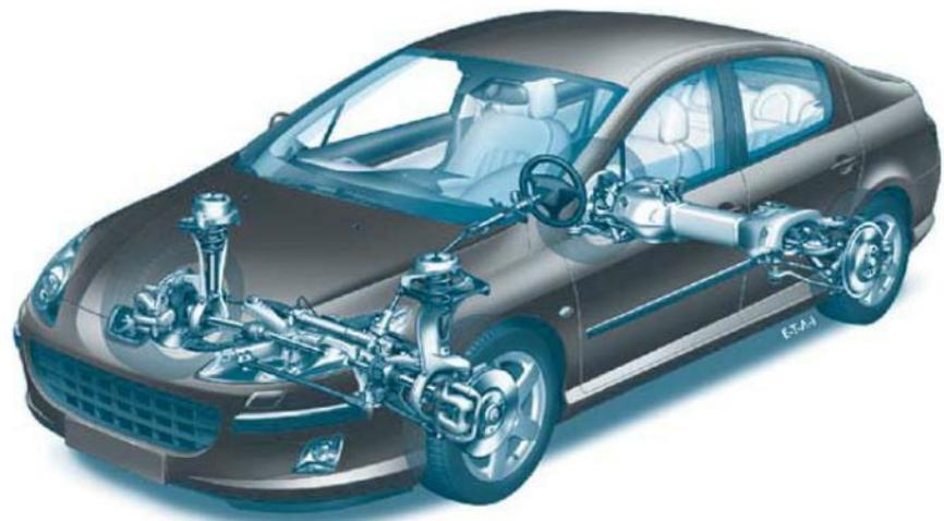
Figure 18.1 *Suspensions pilotées.*
