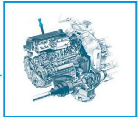
Figure 5.1 Moteur équipé d'une boîte automatique.
