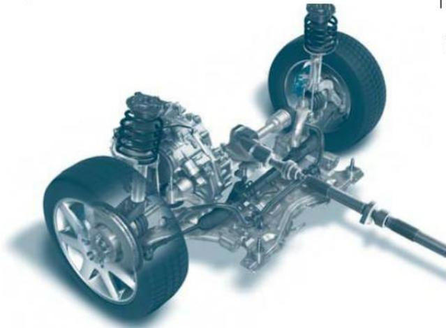
Figure 7.10 Arbre de transmission sur véhicule.
