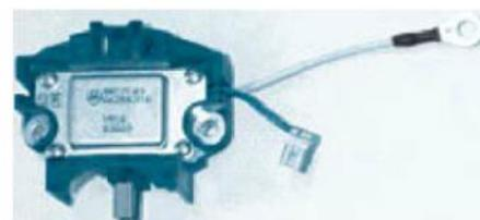
Figure 26.23 Régulateur électronique incorporé.
