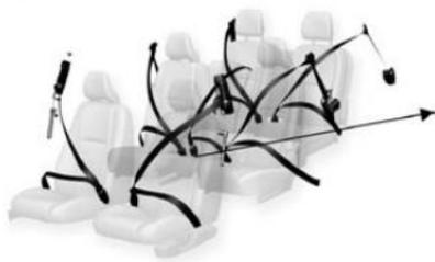
Figure 15.9 Ceintures de sécurité à prétension.
