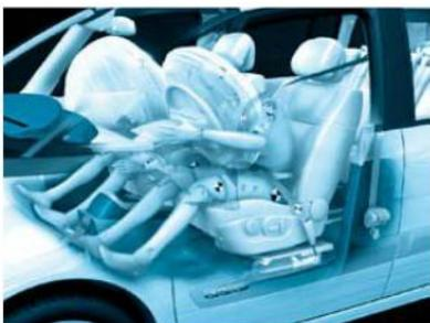
Figure 15.12 Déclenchement d'airbags frontaux.
