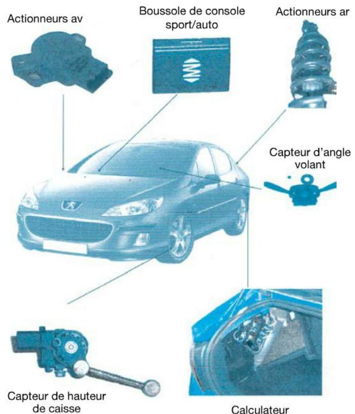
Figure 18.2 Éléments constitutifs de la suspension pilotée.
