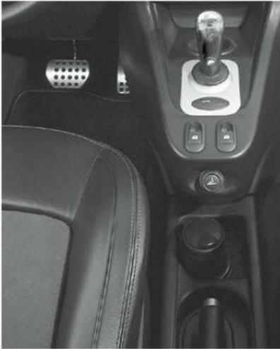
**Figure 11.2B** Dispositif de commande : pédale et frein à main (document PSA Peugeot Citroën).
