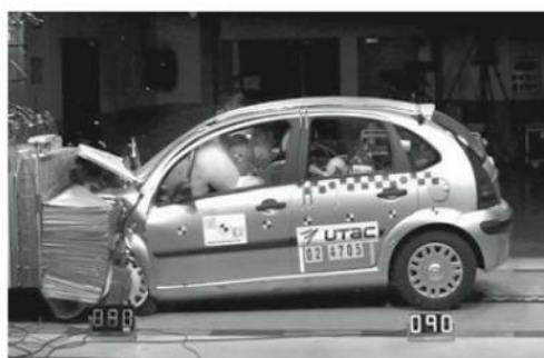
Figure 3.18 Choc frontal à 90 Km/h (Document PSA).
