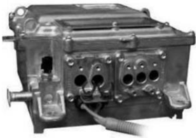
Figure 17.10 Calculateur contrôle machine électrique (CCME).
