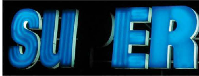
Figure 10.1 – Enseigne lumineuse à tube haute tension.
