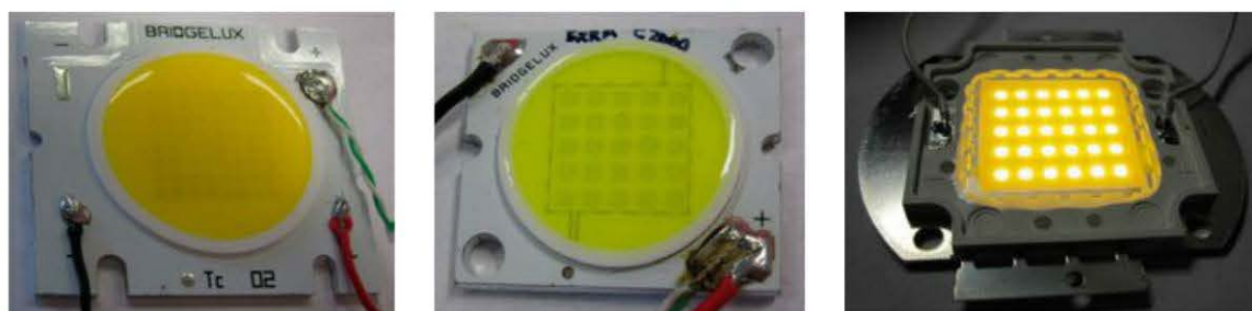
Figure 4.10 – Module COB de gauche à droite : Bridgelux (50 W), Bridgelux (25 W), fabricant asiatique (30 W).
