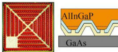
Figure 3.17 – Mise en œuvre de miroir (OSRAM Opto Semiconductor, 2005).
