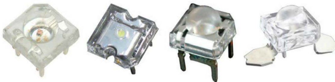
Figure 3.20 – Évolution des boîtiers de LED de type « piranha ».
