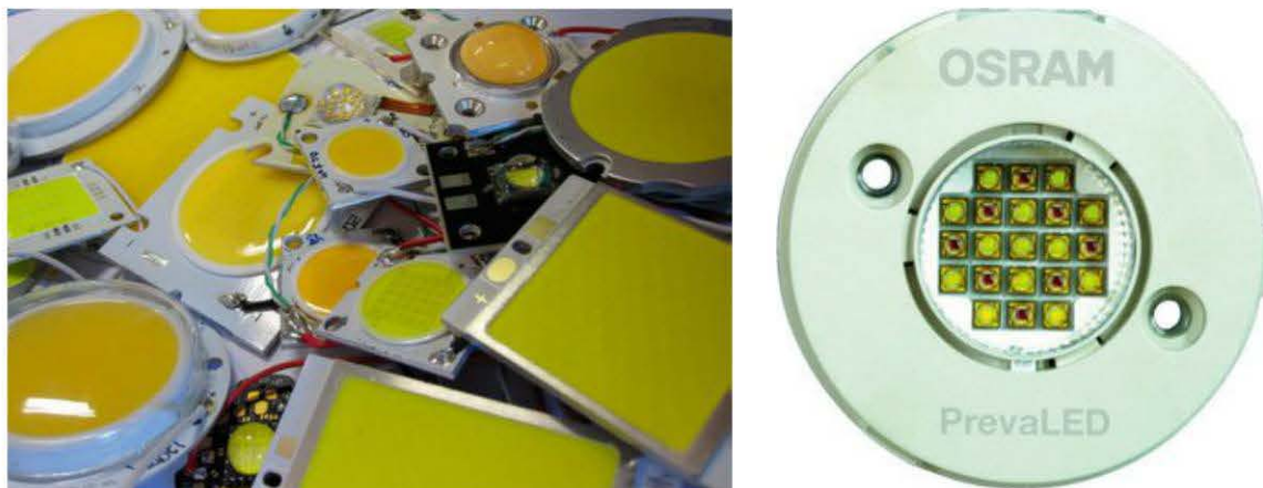
Figure 4.1 – Matrices multipuces (COB, à gauche) et module multi-LED (à droite).
