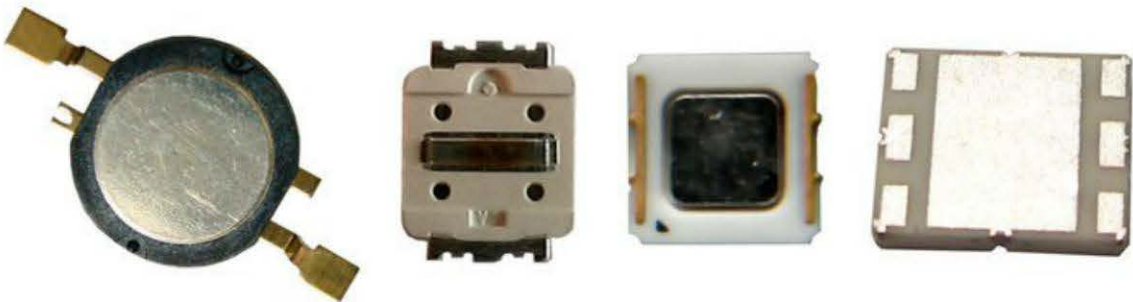
Figure 3.24 – Pad de dissipation thermique de LED CMS, de gauche à droite : Seoul Semiconductor type P4, Nichia types NS6 et Gaia, Seoul Semiconductor type P2-5 RGB.
