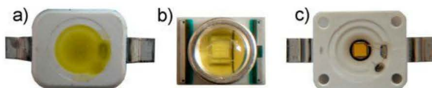
Figure 11.9 – Méthodes de dépôt de luminophore (a et c = Osram ; b = CREE).
