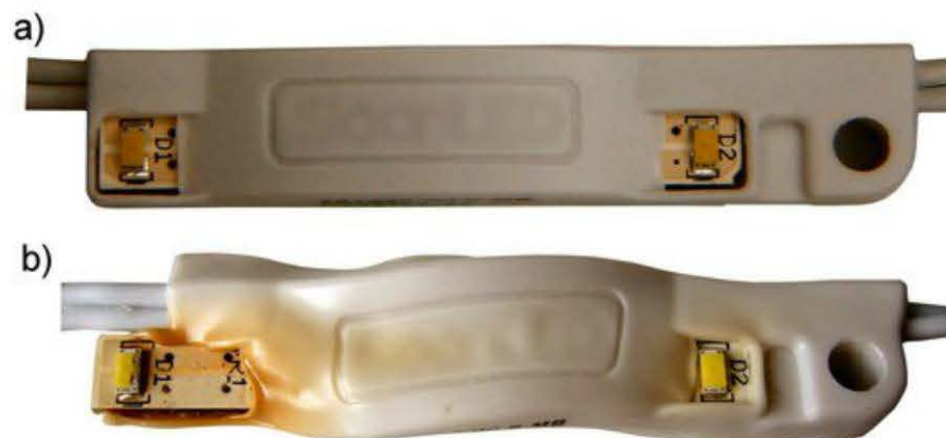
Figure 10.45 – Modules LED avant (a) et après (b) sur tension.
