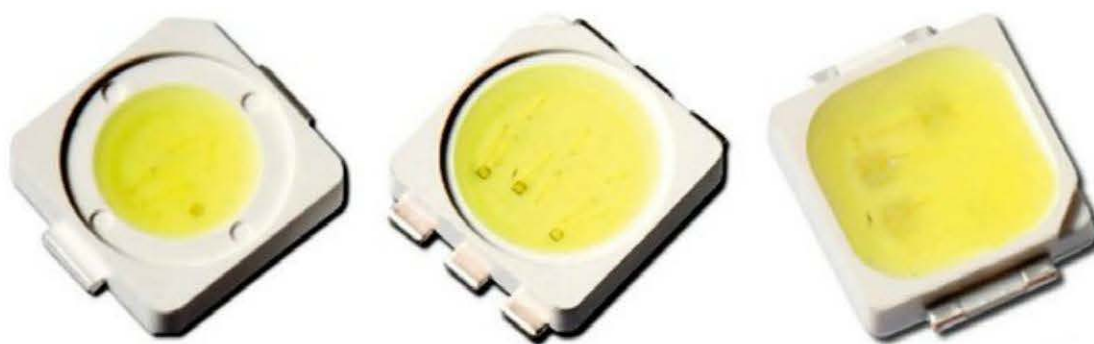
Figure 4.6 – LED multipuces respectivement à 2, 3 et 4 puces.
