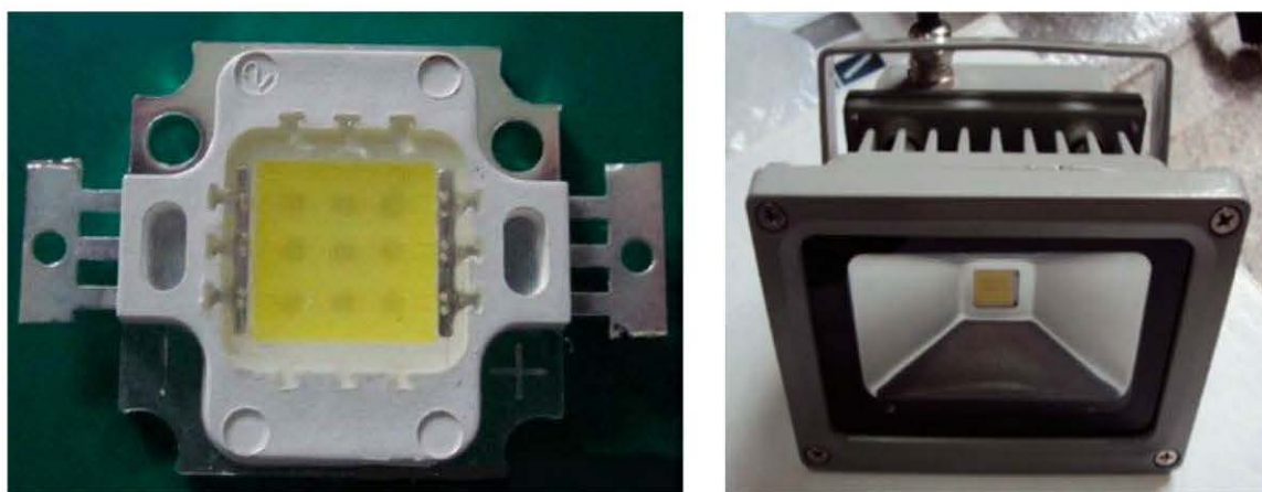
Figure 4.11 – Matrice de 9 puces de 700 \mu\text{m} (droite), projecteur 10 W utilisant une matrice COB (Chine, moins de 15 $).
