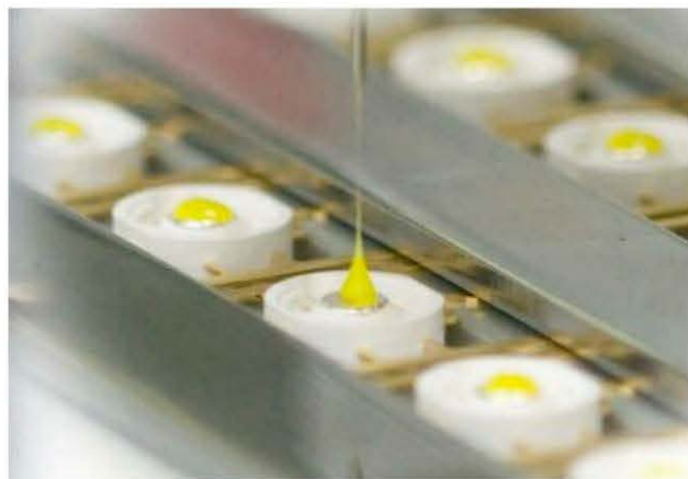
Figure 6.19 – Dépôt de luminophore – Helios Crew Corp.
