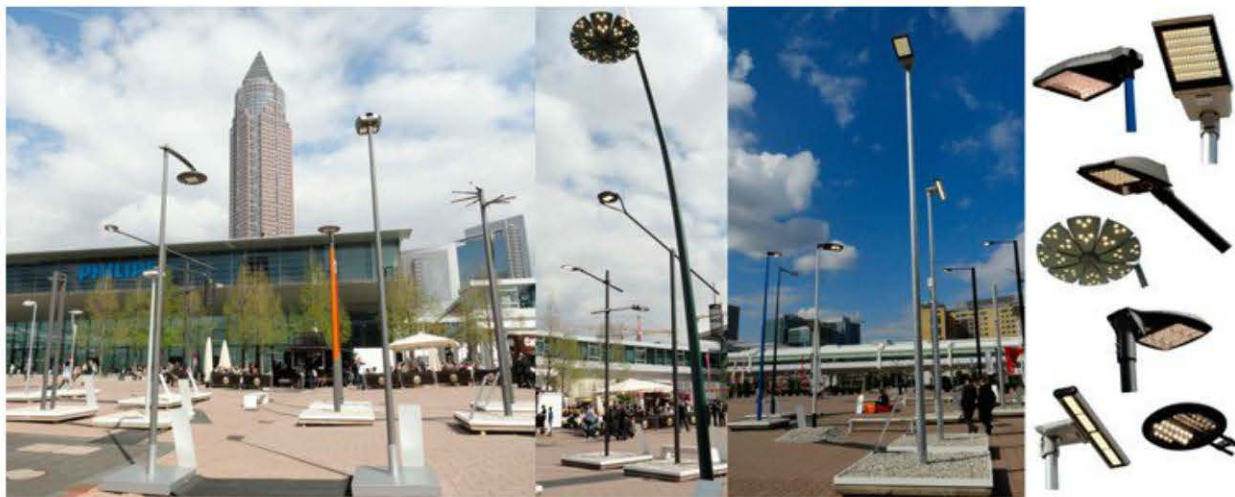
Figure 10.6 – Candélabres à LED (voies principales et secondaires).
