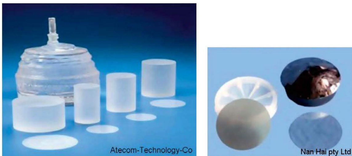
Figure 5.17 – Wafer saphir (gauche) et carbure de silicium (droite).
