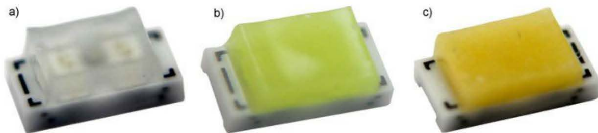
Figure 7.6 – LED avec dôme silicone (Nichia avec a, b et c respectivement des LED verte, blanc froid et blanc chaud).
