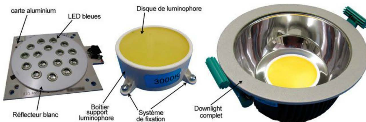
Figure 10.22 – Down light utilisant un module LED à luminophore déporté (Philips).
