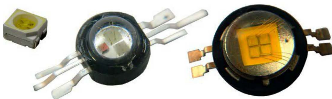
Figure 9.16 – LED multi puce (de gauche à droite : LED de basse puissance Liteon, et deux modèles de LED de puissance Hongliopto (RGB) et Seoul Semiconductor).
