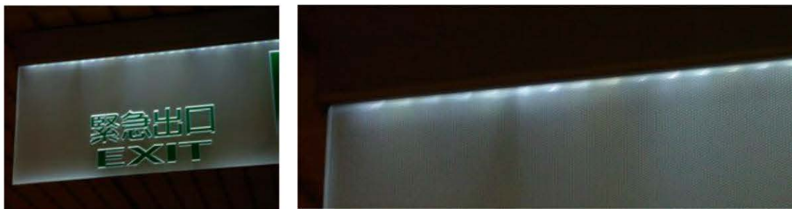
Figure 3.15 – Éclairage par la tranche utilisant des LED de mauvaise qualité colorimétrique.
