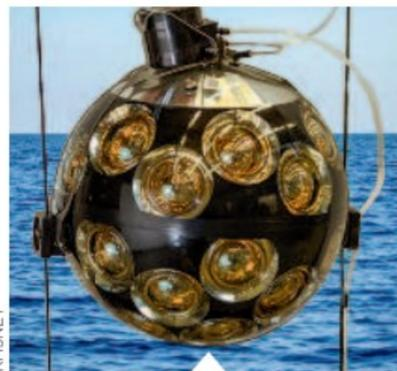
Un des détecteurs de l'instrument KM3NeT.
