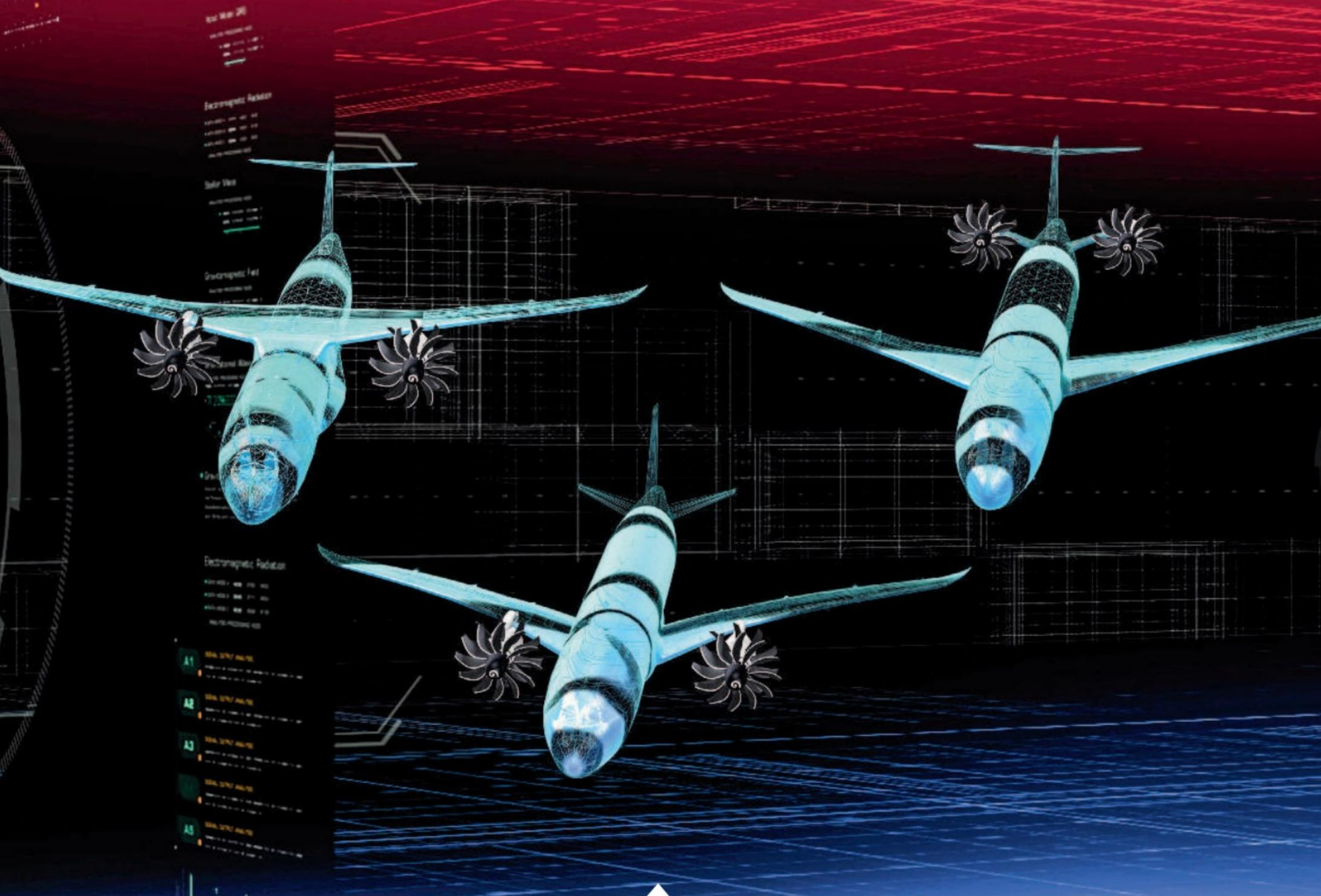
**Le turboréacteur** non caréné de CFM, une coentreprise de Safran et General Electric, est conçu pour permettre des vols avec une réduction de 20 % des émissions de CO<sub>2</sub> et de la consommation de carburant. Sa mise en service est annoncée pour 2035 (vue d'artiste).
