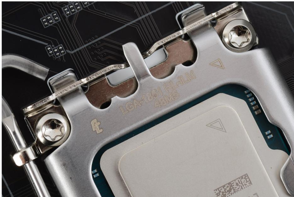
Le socket RL-ILM déforme moins les CPU que le socket ILM, ce qui se traduit par un léger progrès des températures.
