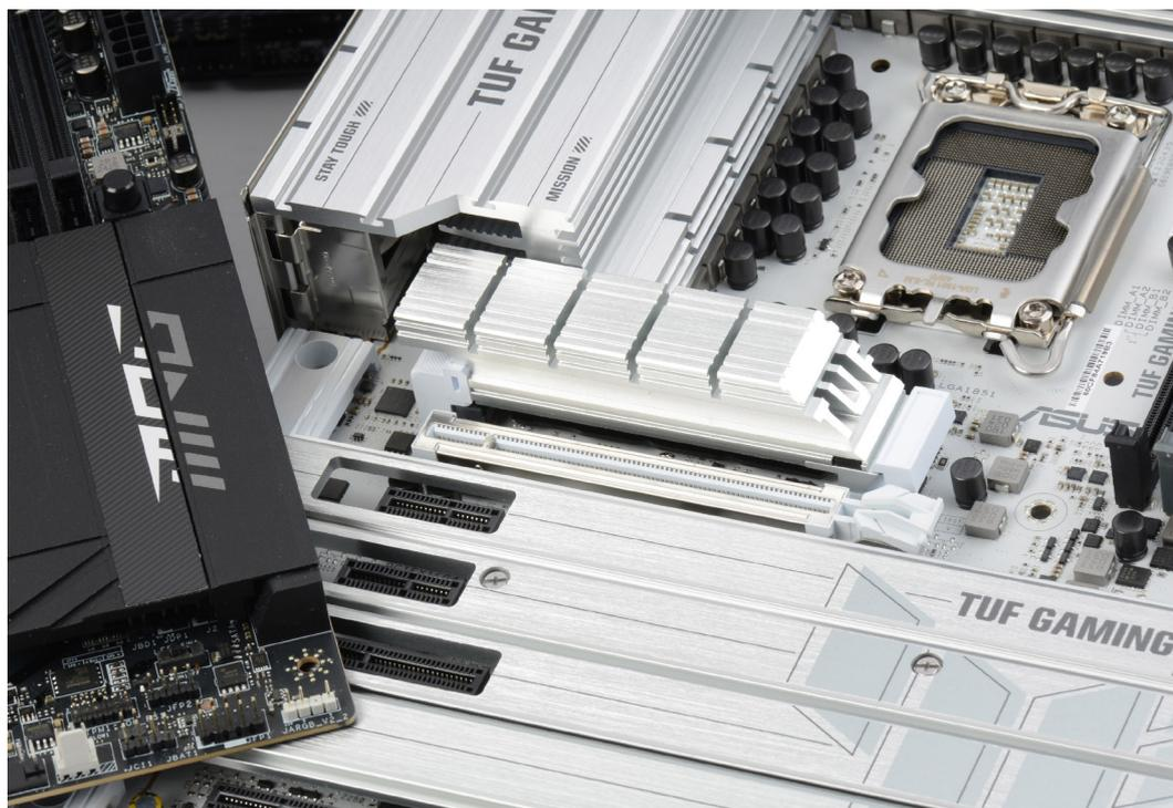
En général, seul le port PCIe X16 le plus haut est câblé sur le CPU, les autres moins rapides sont sur le chipset.
