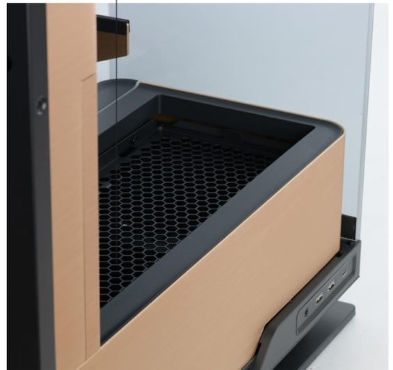
Les prises en façade sont intégrées au pied, sur le flanc, sous la porte en verre de gauche.
