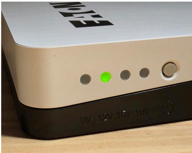
Il est important de choisir la tension de sortie avant de brancher un appareil.
