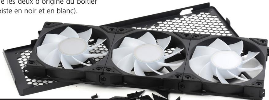
Dans le carter supérieur, un tiroir sur lequel fixer ventilateurs et radiateur se démonte à l'aide d'une vis à main.
