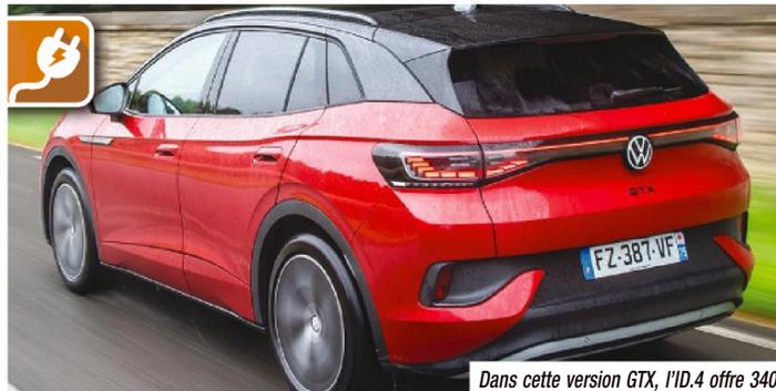
Dans cette version GTX, l'ID.4 offre 340 ch et une transmission 4x4 grâce à un second moteur sur l'essieu avant. Il pèse aussi près de 2,3 tonnes !
