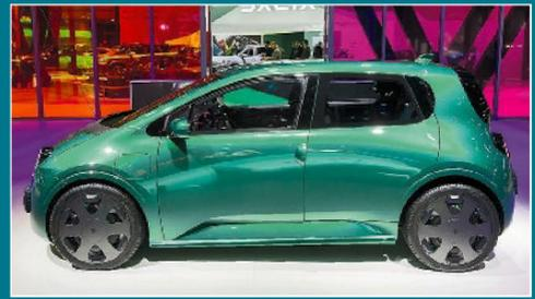
Avec une longueur d'environ 3,77 m, la nouvelle Twingo est plus courte que la R5 électrique (- 15 cm), dont elle reprend la plate-forme.
