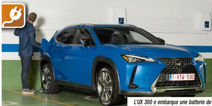
L'UX 300e embarque une batterie de 72,8 kWh, qui ne lui permet pas de faire plus de 313 km d'une traite.
