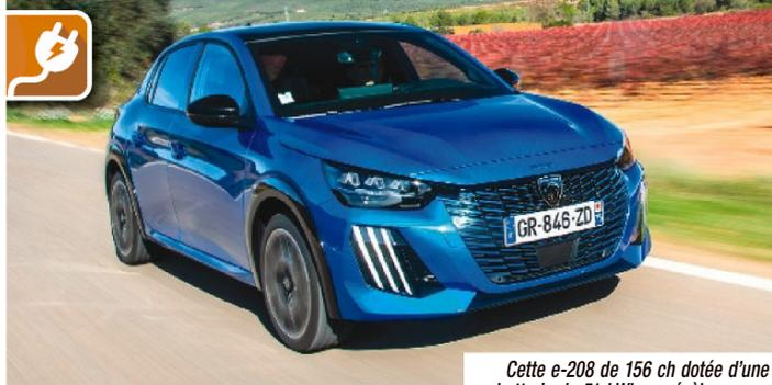
Cette e-208 de 156 ch dotée d'une batterie de 51 kWh se révèle un peu plus tonique que l'offre 136 ch et l'autonomie progresse sensiblement.
