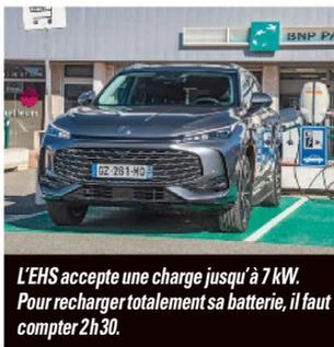
L'EHS accepte une charge jusqu'à 7 kW. Pour recharger totalement sa batterie, il faut compter 2h30.
