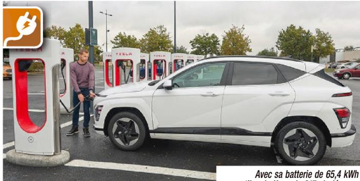
Avec sa batterie de 65,4 kWh utiles, le Kona de 217 ch dépasse allègrement les 400 km d'autonomie.
