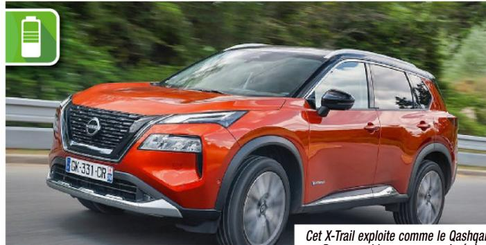
Cet X-Trail exploite comme le Qashqai e-Power un bloc essence qui génère l'électricité distribuée à la batterie et au moteur électrique via un onduleur.
