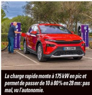
La charge rapide monte à 175 kW en pic et permet de passer de 10 à 80% en 28 mn : pas mal, vu l'autonomie.
