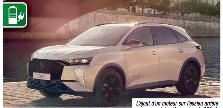
L'ajout d'un moteur sur l'essieu arrière permet à cette version de 300 ch de s'affranchir plus facilement de conditions d'adhérence précaires.
