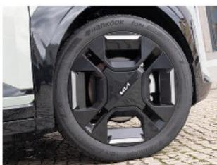
Les roues de 19" de la finition GT-line font baisser l'autonomie en cycle mixte de 605 à 563 km.
