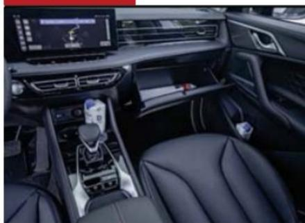
L'imposant levier de vitesses empiète sur les rangements de la console centrale, tout juste dans la moyenne. L'emplacement pour loger le téléphone apparaît cependant suffisant, et comporte un chargeur par induction.
