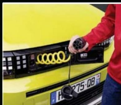
C'est le détail qui fait mouche sur l'italienne : le câble de recharge 7 kW en courant alternatif est directement intégré à l'auto (sauf avec l'option à 11 kW). Il suffit d'ouvrir la trappe, située sur la calandre, pour le sortir et se brancher à une borne. De plus, sa forme en spirale évite qu'il traîne au sol et facilite sa remise en place. A bord, la Grande Panda se montre généreuse en espaces de rangement.
