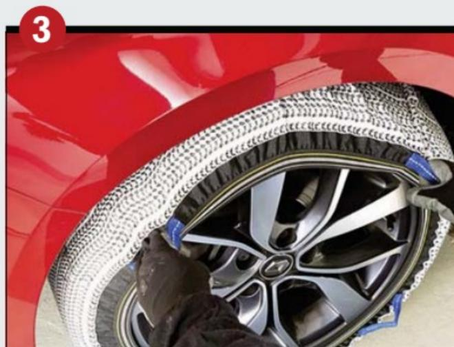
**Ajustez la chaussette.** En déplaçant l'élastique de droite à gauche derrière la roue, la chaussette peut se désaxer par rapport au centre de la jante. Tirez alors l'élastique extérieur de chaque côté vers le bas pour améliorer le centrage de l'ensemble.
