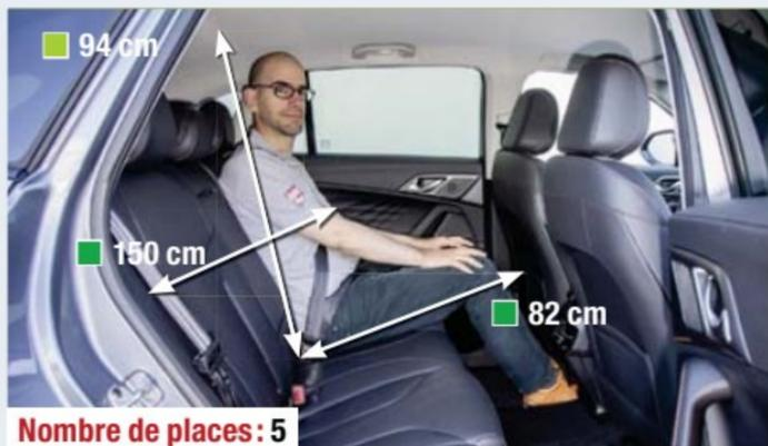
Grâce à ses dimensions plus que généreuses, le MG EHS propose une habitabilité remarquable aux occupants des places arrière, tant en largeur aux coudes qu'en place aux jambes.
