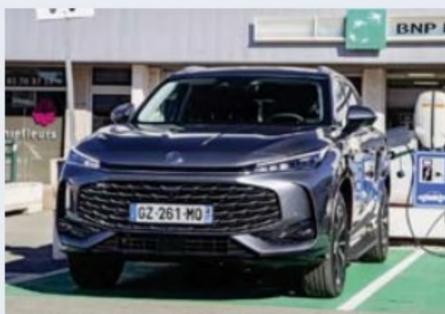
L'EHS accepte une charge jusqu'à 7 kW. Pour recharger totalement sa batterie, il faut compter 2 h 30.
