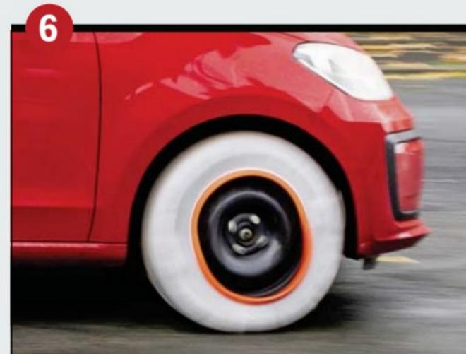
**Faites un test de roulage.** Roulez à une vitesse modérée (20 à 30 km/h) sur quelques centaines de mètres en ouvrant bien grand vos oreilles. A cette vitesse, aucun bruit suspect ne doit se faire entendre. Arrêtez-vous pour contrôler que le centrage automatique a bien opéré.
