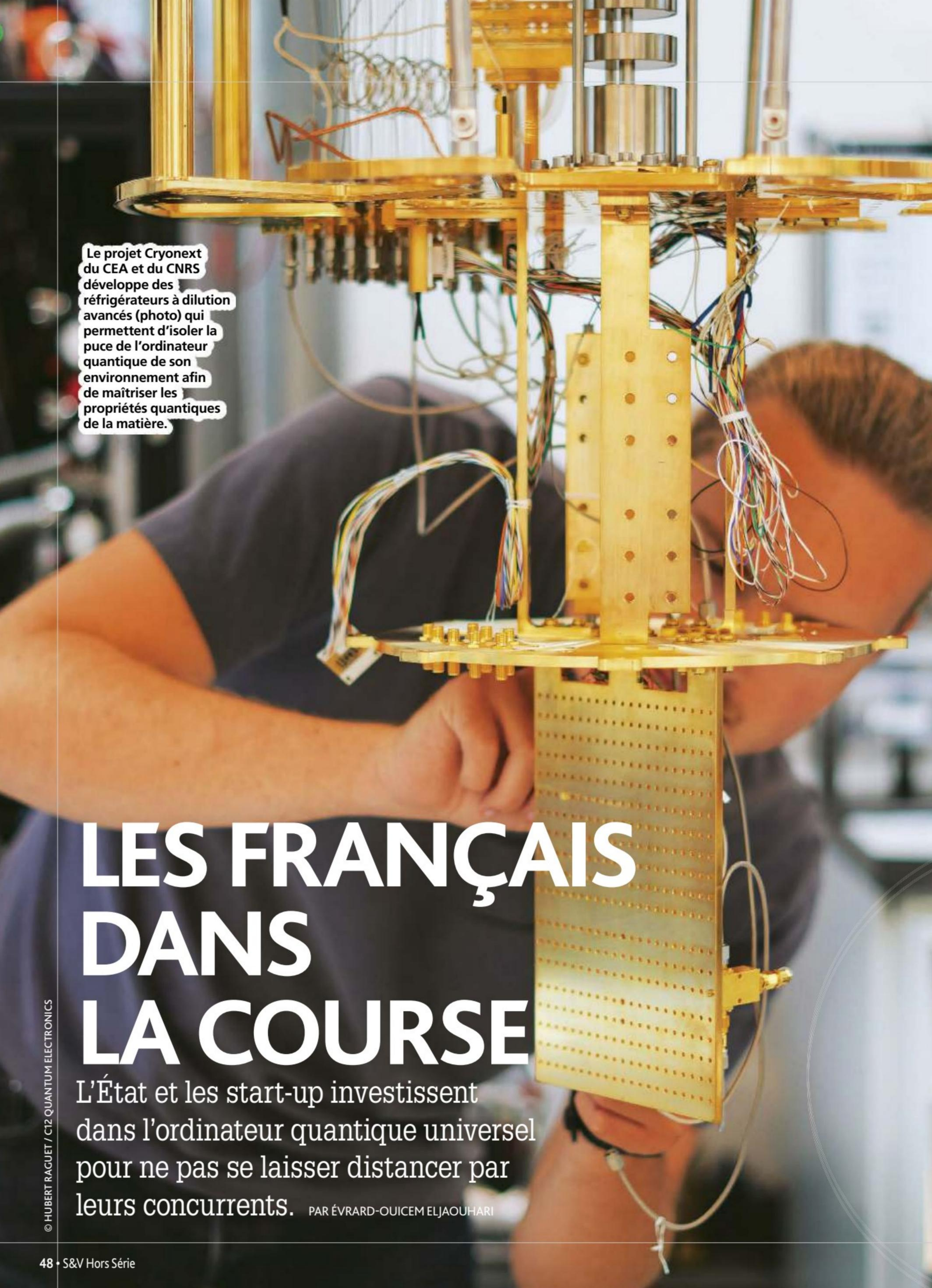
Le projet Cryonext du CEA et du CNRS développe des réfrigérateurs à dilution avancés (photo) qui permettent d'isoler la puce de l'ordinateur quantique de son environnement afin de maîtriser les propriétés quantiques de la matière.
