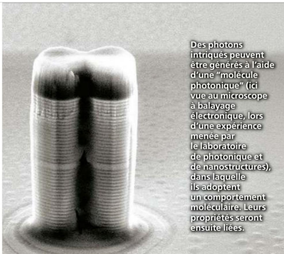
Des photons intriqués peuvent être générés à l'aide d'une "molécule photonique" (ici vue au microscope à balayage électronique, lors d'une expérience menée par le laboratoire de photonique et de nanostructures), dans laquelle ils adoptent un comportement moléculaire. Leurs propriétés seront ensuite liées.
