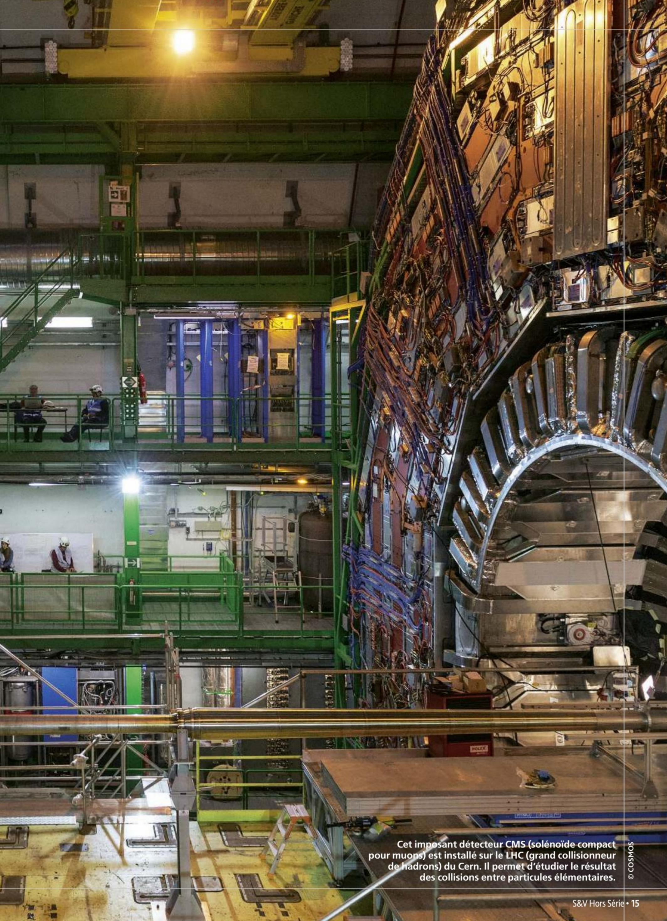
Cet imposant détecteur CMS (solénoïde compact pour muons) est installé sur le LHC (grand collisionneur de hadrons) du Cern. Il permet d'étudier le résultat des collisions entre particules élémentaires.
