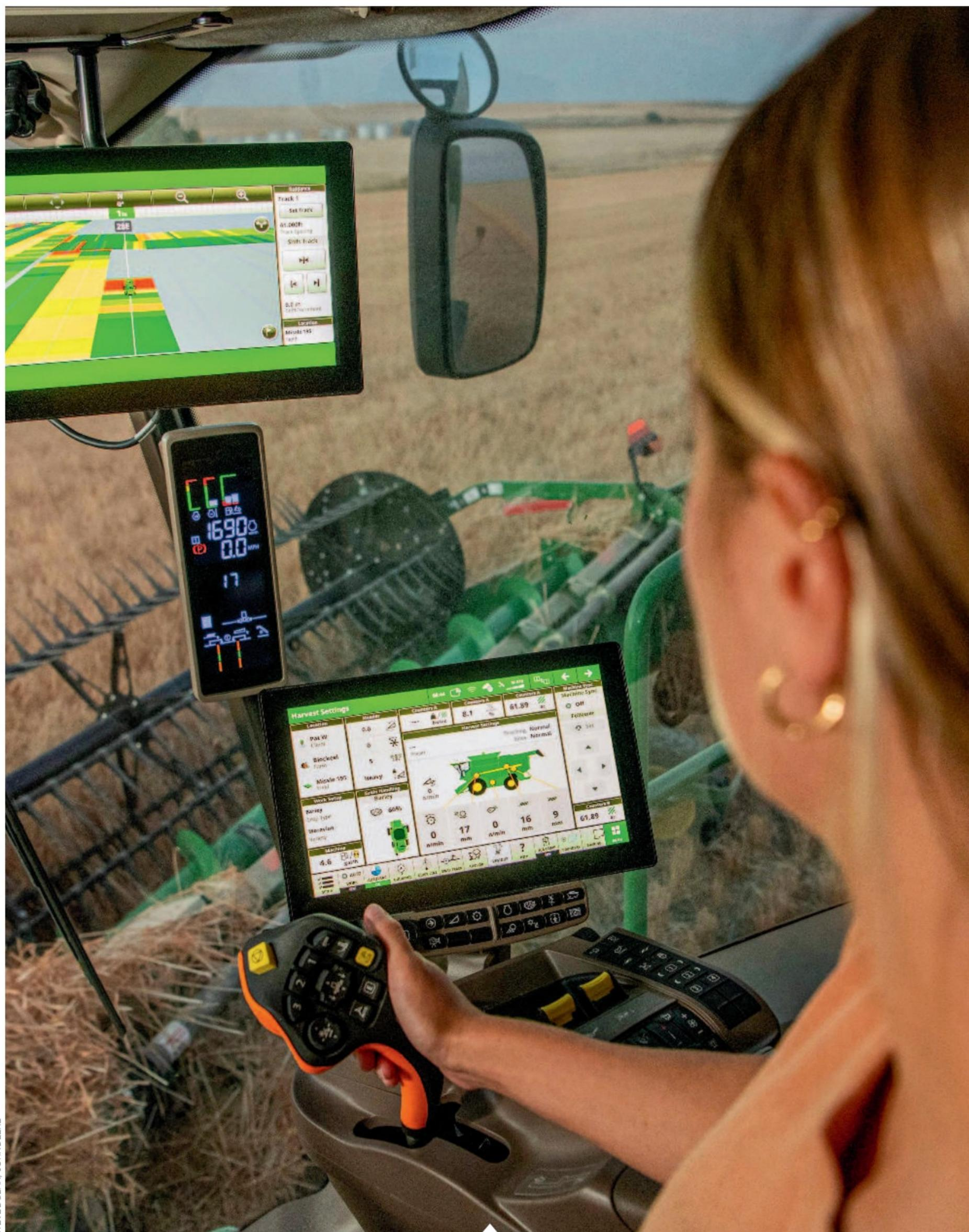
**Les consoles intégrées sur les machines** agricoles affichent de nombreuses données (intrants, travail du sol, etc.) afin de répondre aux besoins spécifiques des plantes et d'optimiser le rendement des cultures (ici une moissonneuse connectée aux États-Unis).
