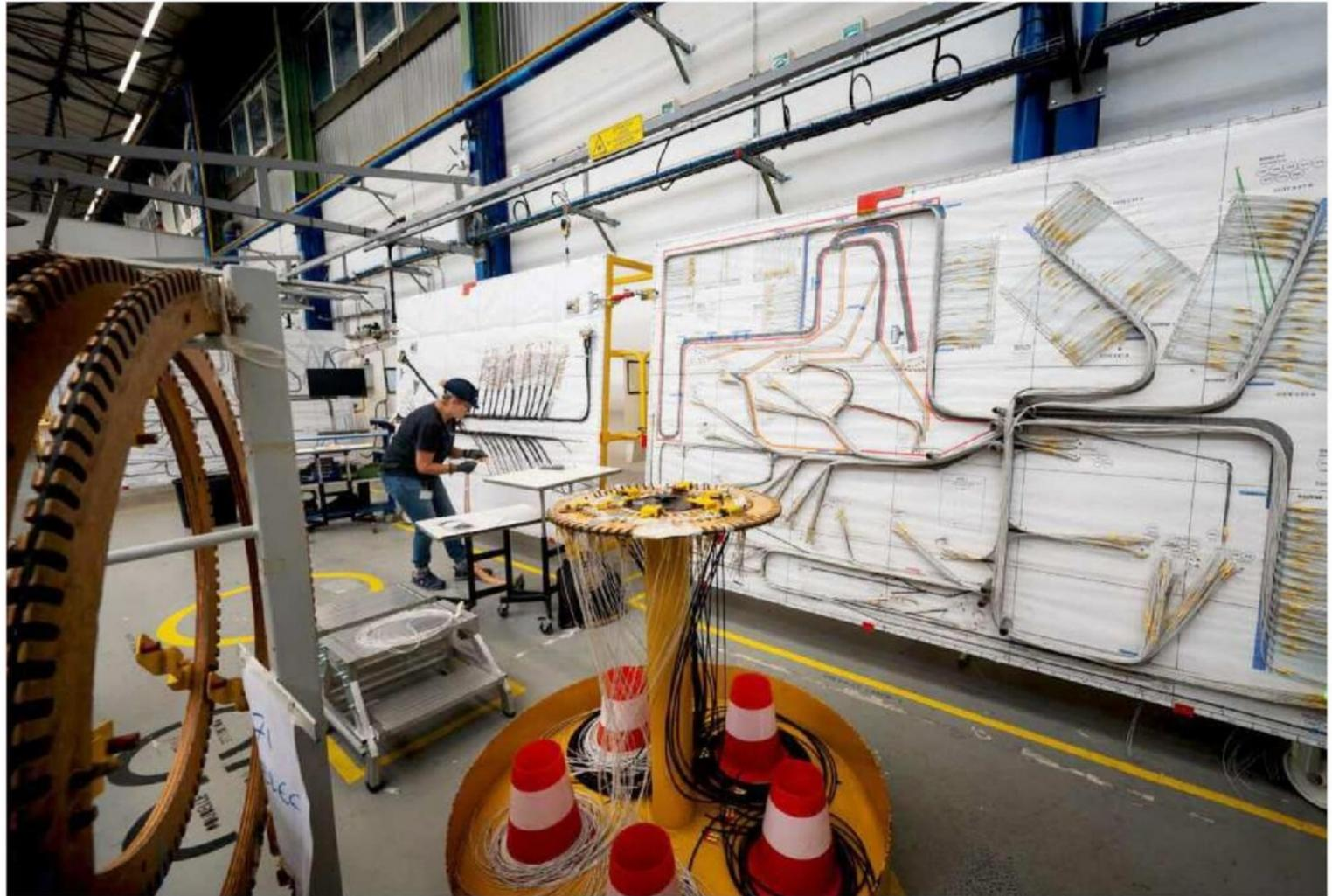
Cette étape marque la suite du travail de l'installation électronique. Autrefois, les câbles étaient montés dans le train pour y être posés à la main. Désormais, un bras de câblage s'en charge. Ce qui facilite l'intervention des opérateurs, qui ne réalisent plus que les finitions à bord.
