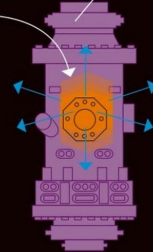
Les rayons lumineux rebondissent dans des cubes d'or et de platine, des masses inertielles, flottant en chute libre dans chaque satellite.
