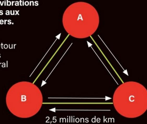
Chaque satellite combine son propre laser avec ceux des deux autres dans des interféromètres. Ces derniers mesurent la distance entre les engins.
