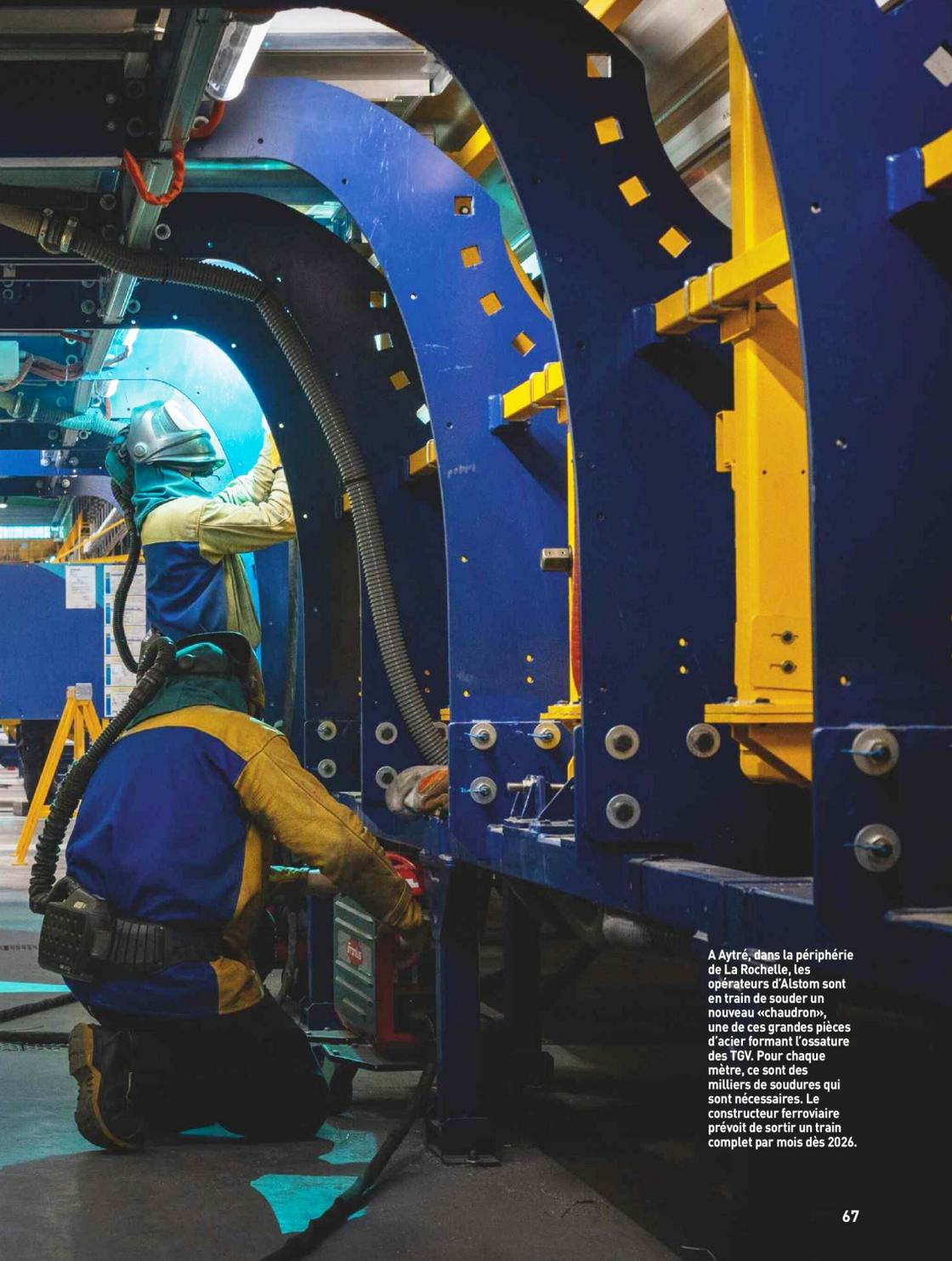
A Aytré, dans la périphérie de La Rochelle, les opérateurs d'Alstom sont en train de souder un nouveau «chaudron», une de ces grandes pièces d'acier formant l'ossature des TGV. Pour chaque mètre, ce sont des milliers de soudures qui sont nécessaires. Le constructeur ferroviaire prévoit de sortir un train complet par mois dès 2026.
