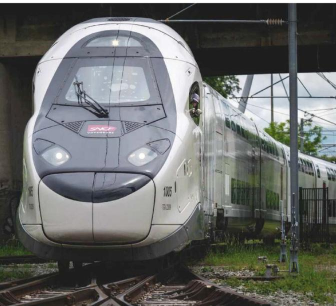
Le TGV-M à double étage disposera de 20% de capacité en plus à bord, soit 740 sièges au design épuré par rame, contre 634 aujourd'hui. Il sera aussi le premier train 100% accessible en fauteuil roulant.
