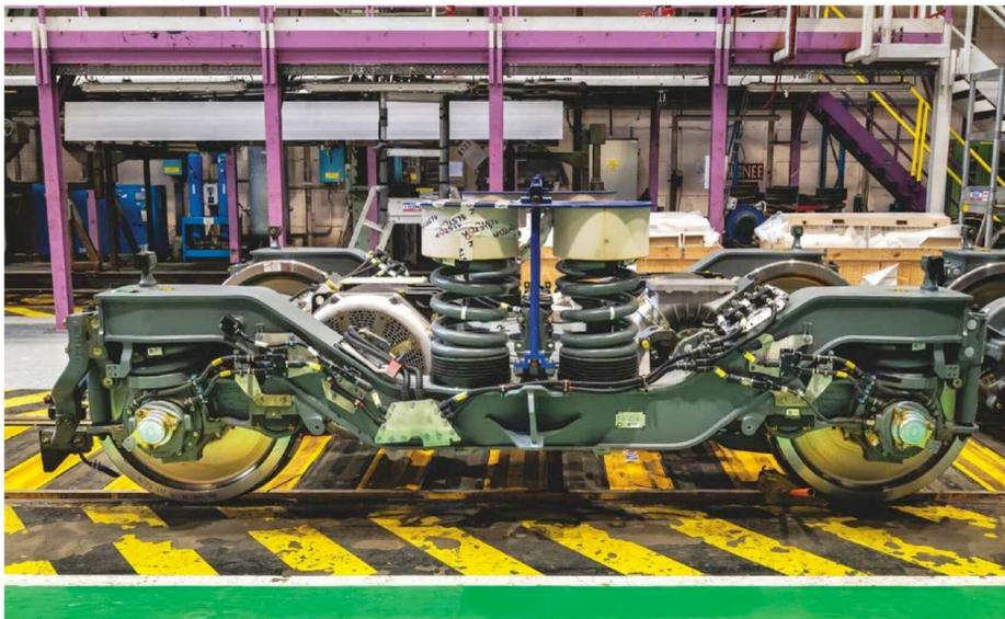
Le bogie constitue l'interface entre le véhicule ferroviaire et les rails, et supporte les essieux. Sur ce modèle, qui accueillera un moteur sur ses deux grosses suspensions, la durée de vie des roues est d'environ 500 000 kilomètres, soit le parcours moyen d'une rame de TGV en un an.
