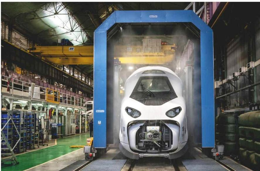
En bout de ligne de production, chaque nouvelle rame est inspectée pour vérifier son étanchéité, comme ici à Belfort. L'eau pouvant pénétrer à chaque jonction de pièces, les opérateurs d'Alstom vérifient à l'œil nu si des gouttes ne passent pas à l'intérieur des voitures.
