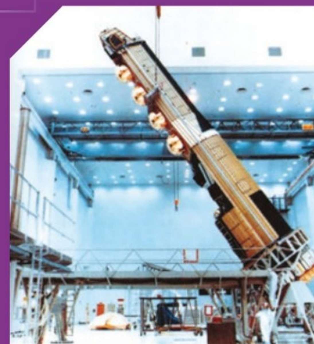
Le KH-9 mesurait 16 mètres de long et pesait 11 tonnes.
