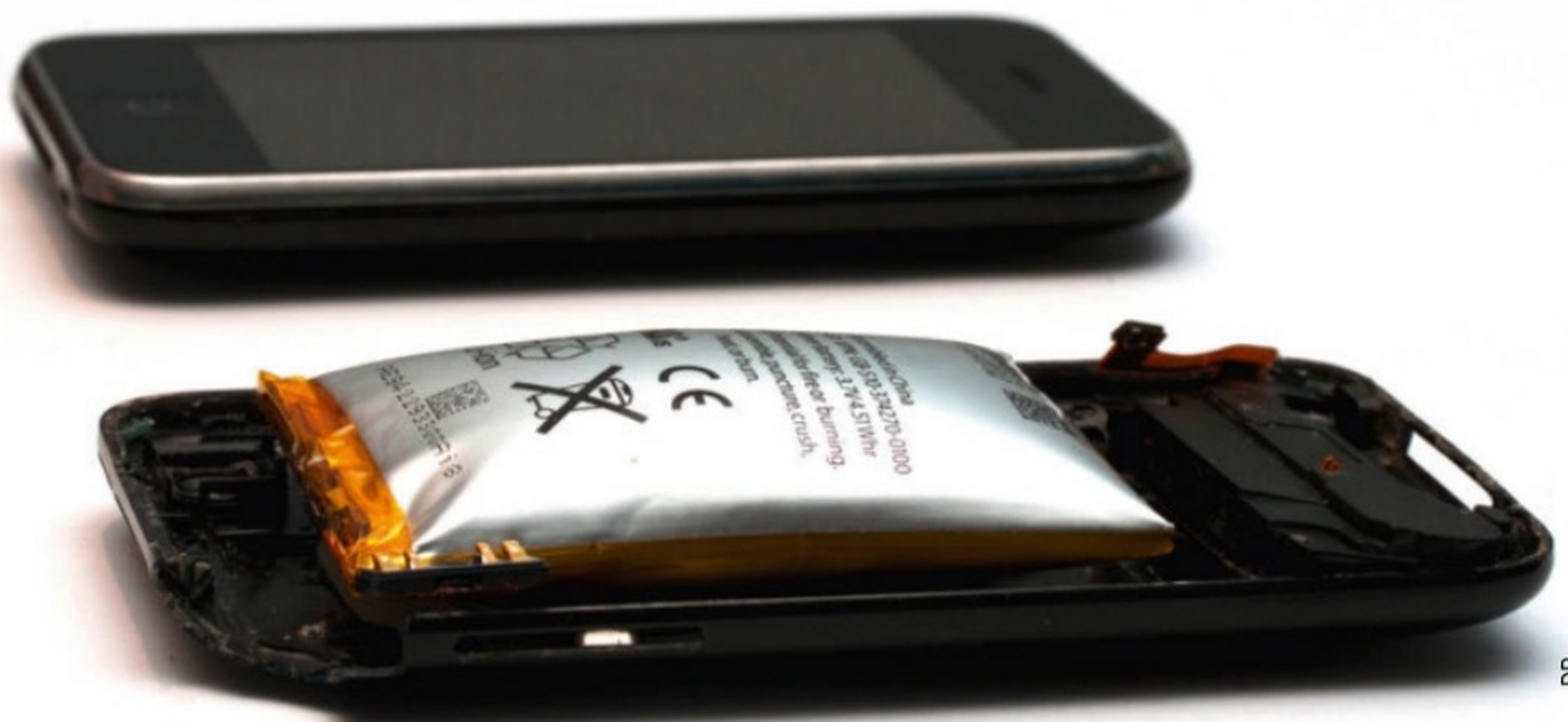
▲ Le problème des batteries Li-ion est leur relative dangerosité. Ici un iPhone dont la batterie Li-Po a gonflé... Attention, danger.
