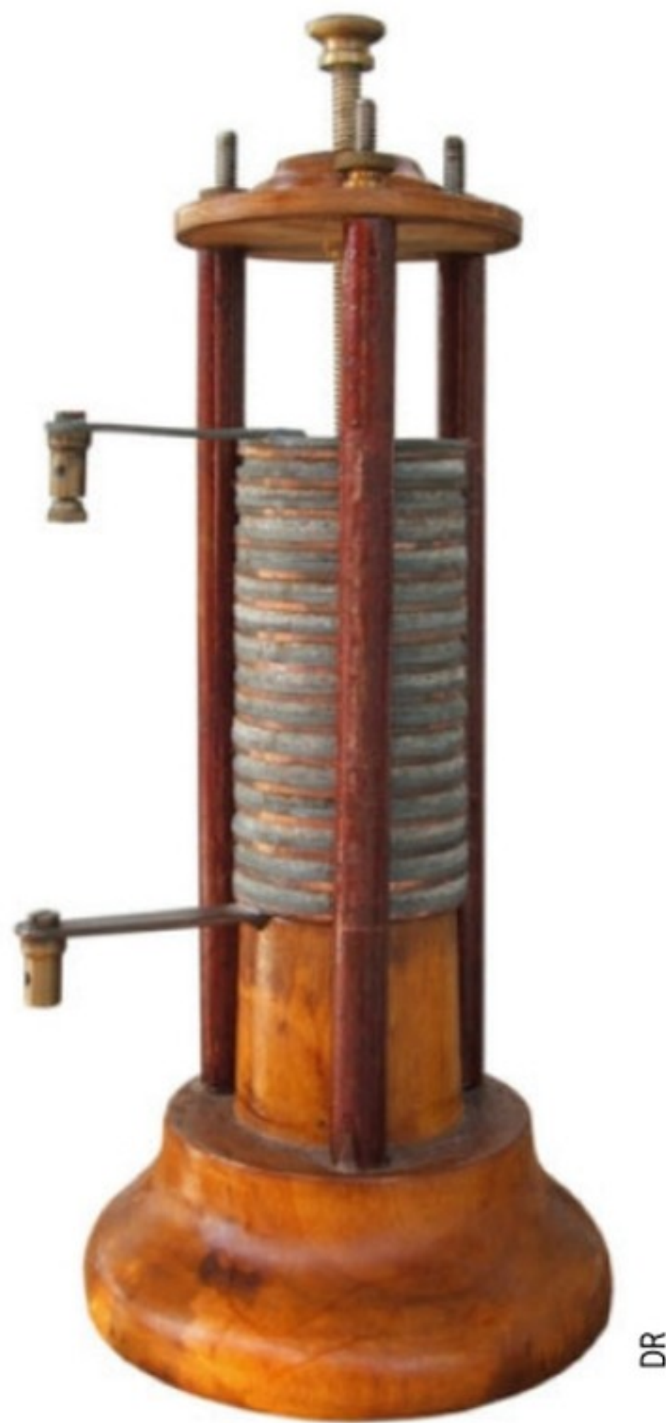
▲ La pile de Volta, présentée en 1800, fut la première mise en pratique de la production de courant par réaction chimique. Si la technologie a beaucoup évolué, le principe fondamental est resté inchangé.
