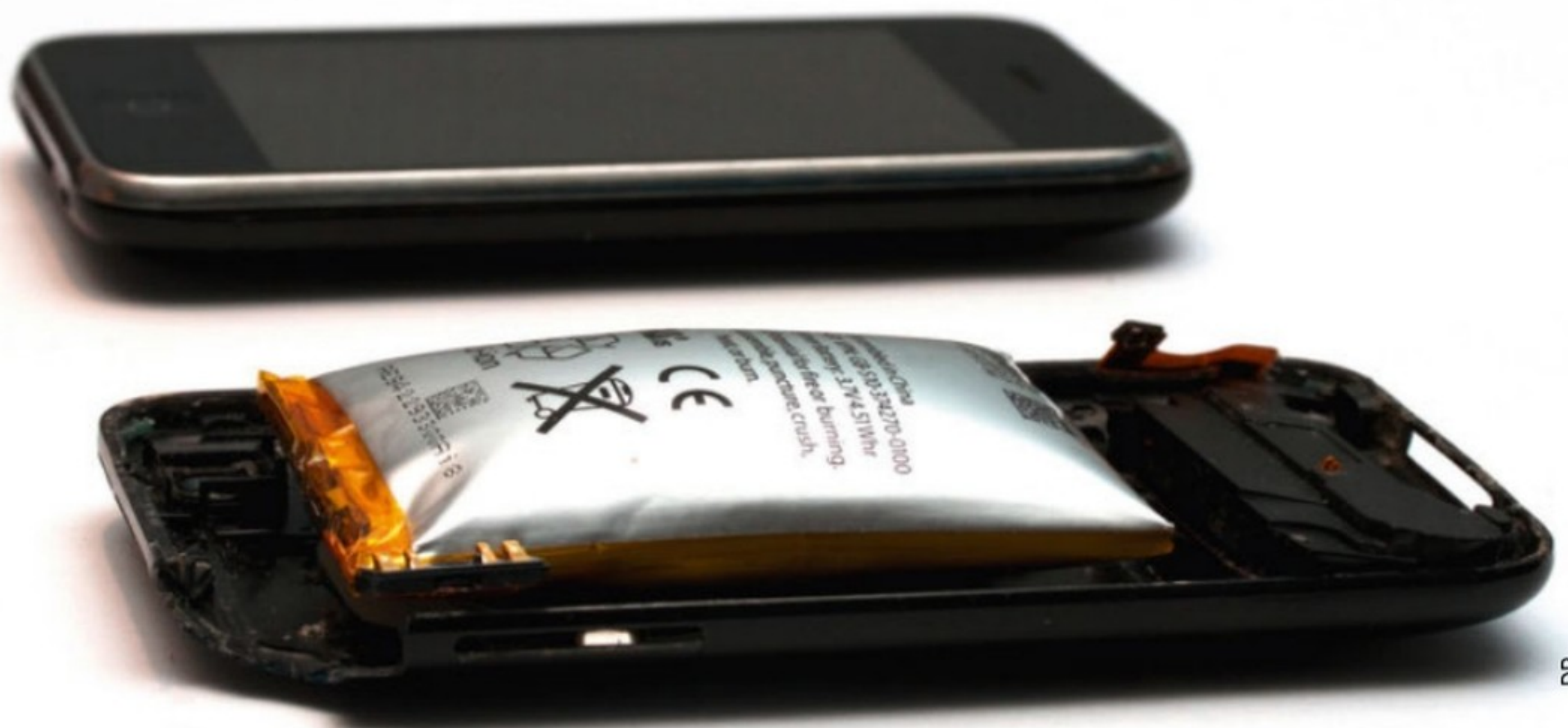
▲ Le problème des batteries Li-ion est leur relative dangerosité. Ici un iPhone dont la batterie Li-Po a gonflé... Attention, danger.
