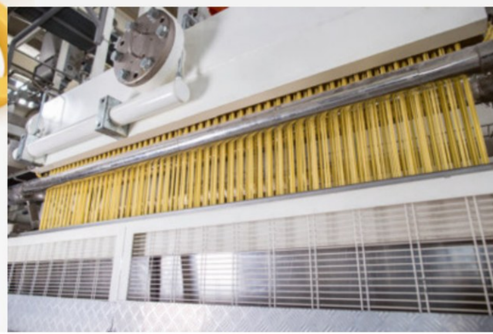
En usine, les pâtes sont découpées par un grand laminoir, puis vont sécher sur un tapis roulant qui vibre légèrement.
