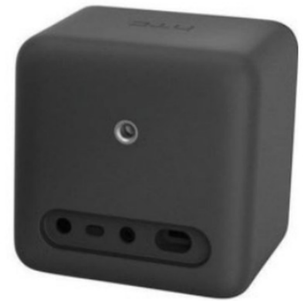
▲ À fixer en hauteur pour dominer la zone d'évolution, les stations de détection permettent au système de voir le casque, les contrôleurs et de transmettre les informations aux logiciels.
