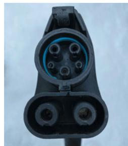
**Étape 1 :** Branchez le pistolet de recharge compatible au véhicule. Le voyant rouge s'allume sur le pistolet CHAdeMo.
