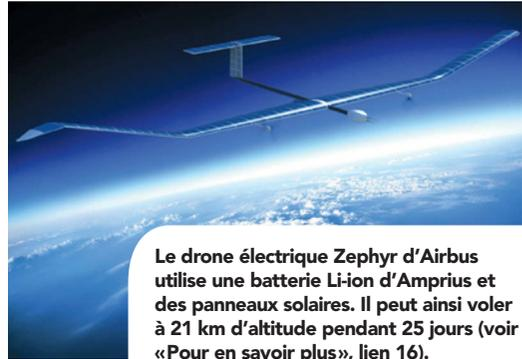
**Le drone électrique Zephyr d'Airbus utilise une batterie Li-ion d'Amprius et des panneaux solaires. Il peut ainsi voler à 21 km d'altitude pendant 25 jours (voir «Pour en savoir plus», lien 16).**
