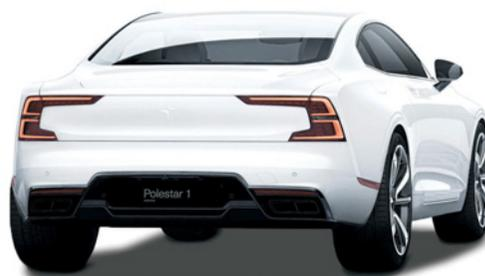
même architecture SPA dont on a raccourci l'empattement de 245 mm. Sans compter la structure en fibre de carbone qui renforce son plancher de 60 % et l'allège un peu.
