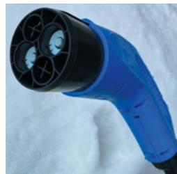
**Étape 4 :** Lorsque la recharge est terminée, retirez le pistolet du véhicule. Enroulez le câble sur le support, rangez le pistolet dans son logement et refermez la porte de la borne pour conclure la transaction. Il arrive encore que certains électromobilistes ne replacent pas correctement le pistolet et le câble, ce qui peut faire en sorte qu'il sera arraché ou sectionné par inadvertance. Donc, assurez-vous de bien le ranger.
