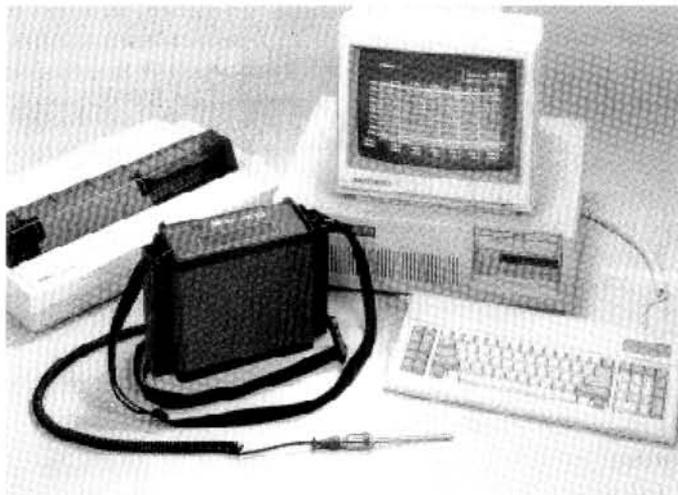
Figure 3.6 – Matériel de mesure et d'analyse des vibrations. (Photo © Schenck.)
