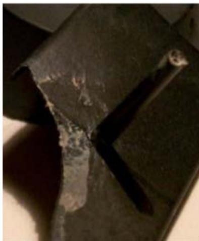
**Photo 17** – Rupture après délaminage. Les traces claires indiquent la présence d'un mélange de matières incompatibles, ou un excès de colorant maître.
