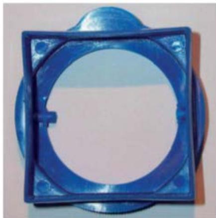
**Photo 16** – Déformation en as de carreau, typique d'un matériau cristallin moulé dans un outillage trop froid.
