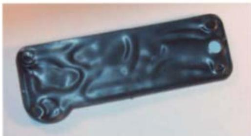
**Photo 9** – Retassure (la retassure généralisée est caractéristique d'un maintien inefficace).
