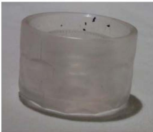
**Photo 36** – Points noirs de fortes dimensions, regroupés dans une zone limitée de la pièce. C'est une dégradation localisée de la matière qui est en cause.
