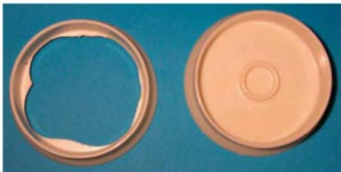
**Photo 41** – Rupture de type 2 : la pièce de gauche a éclaté sous l'effet de la dépression au moment de l'éjection.
