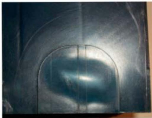
**Photo 6** – Bulle d'air unique et importante due à un défaut d'étanchéité de la buse (moulage en canal chaud).
