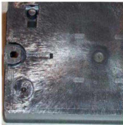
**Photo 20** – Givrage réparti sur la totalité de la pièce. Lorsqu'il est aussi étendu, un étuvage insuffisant de la matière est la cause la plus vraisemblable du givrage.
