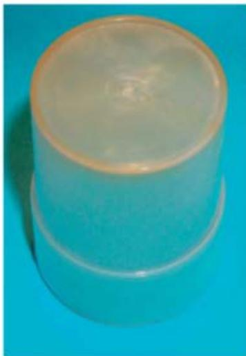
**Photo 52** – Traces marron dues à la dégradation de la matière dans des canaux chauds. Cette dégradation est normale si la presse a subi un long arrêt (on ne peut pas toujours purger les canaux chauds).
