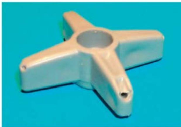
**Photo 40** – Refusion avec fortes dépressions dues à un maintien insuffisant.
