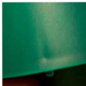
**Photos 10 et 11** – Retassures ponctuelles dues à la présence d'une nervure ou d'un godron sur la face postérieure de la pièce.
