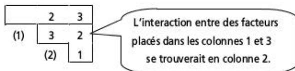
Figure 9.7 – Triangle des interactions de la table  $L_4 (2^3)$ .
