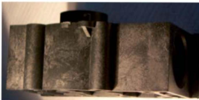
**Photo 43** – Ségrégation de phase (l’aspect « martelé » de la surface est dû aux fibres de verre prisonnières de la gaine solide).
