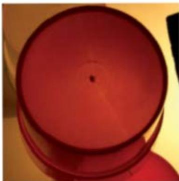
**Photo 50** – Trace de flux provoquée par une température insuffisante des canaux chauds.
