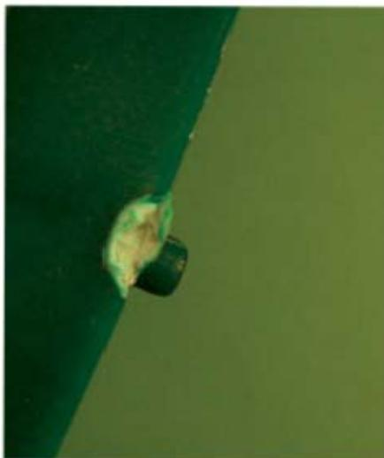
**Photo 35** – Seuil blanchi par la rupture (ce défaut est typique du S/B, de l'ABS et, dans une moindre mesure, du PP).
