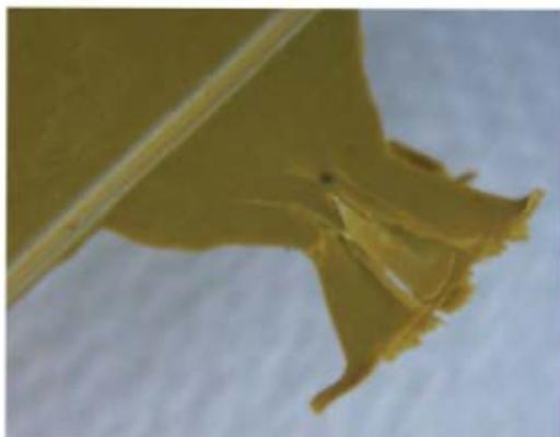
**Photo 19** – Rupture d'un seuil par délaminage.
