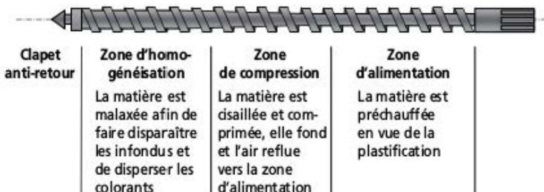
Figure 4.23 – Profil d'une vis de plastification.
