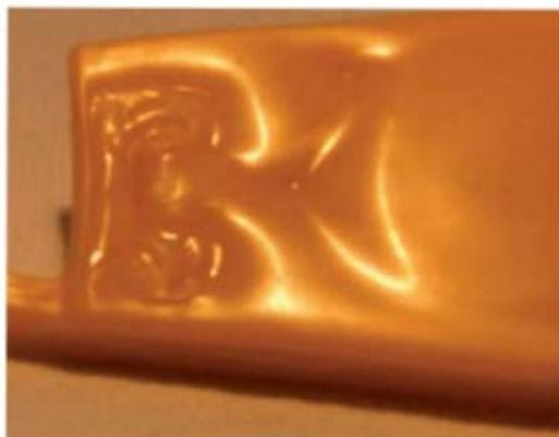
**Photo 38** – Refusion d'une pièce massive en PE-LLD (détail).
