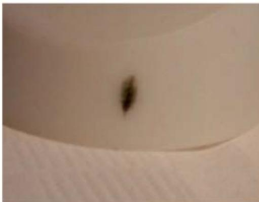
**Photo 13** – Détail d'un coup de feu placé à la rencontre de deux fronts de flux.
