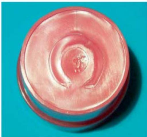
**Photo 55** – Surmoulage accidentel d'un extrudat de moule à canal chaud (ce défaut est semblable au surmoulage d'un fil).
