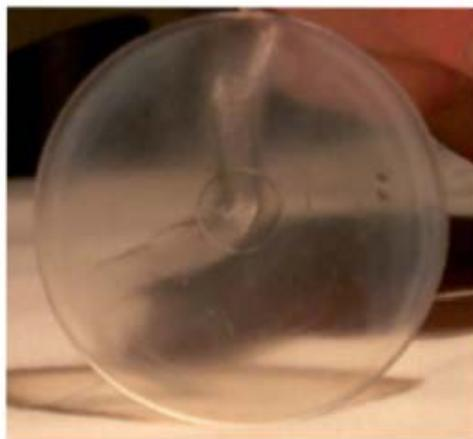
**Photo 26** – Sur une pièce transparente, le jet libre prend l'aspect d'une trace translucide.
