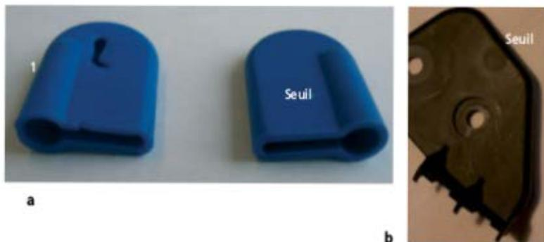
**Photos 2** – (a) Pièce incomplète pour cause de flexion de la broche centrale. Un travail d'optimisation de la vitesse d'injection et de la température de la matière s'impose pour optimiser le réglage. S'il avait été possible de placer le seuil en (1), la soudure se serait effectuée sans difficulté.
