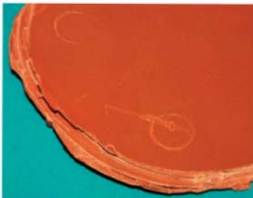
**Photo 18** – Délaminage très important, suite à une purge insuffisante du fourreau.
