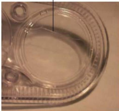
**Photo 30** – Une ligne de soudure sinueuse apparaît sur les pièces dont les épaisseurs ne sont pas constantes.
