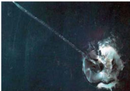
**Photo 54** – Trace de fil (le fil de matière est resté accroché à la buse moule, puis il a été surmoulé à l'injection suivante).
