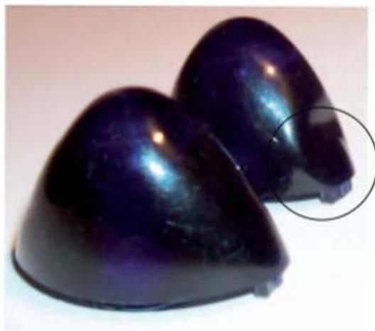
**Photo 39** – Refusion tardive sur des pièces aux formes arrondies (ce type de refusion peut être difficilement repérable).
