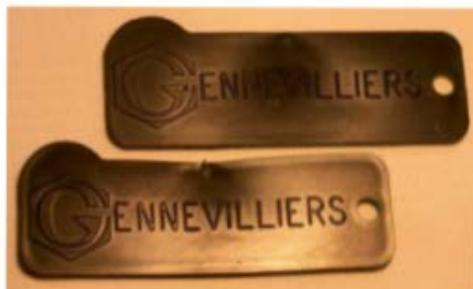
**Photo 1** – Injection trop rapide : les deux pièces ci-dessus ont été produites avec des réglages identiques, seule la vitesse d'injection a été augmentée pour le moulage de la pièce 2.
