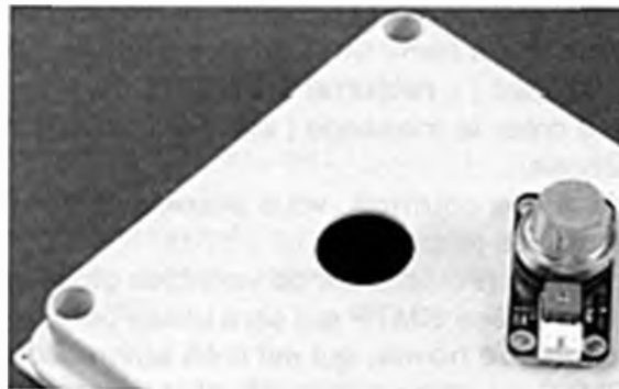
Figure 4.11 Trou pour le capteur de fumée
