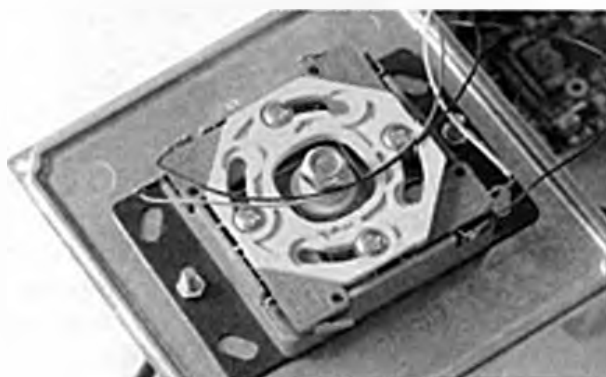
Figure 6.26 Soudure des câbles.
