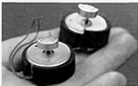
Figure 6.14 Récupération de moteurs de vibration.
