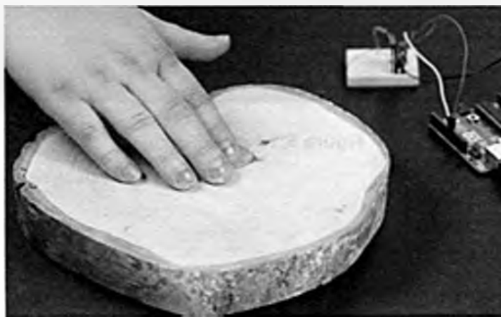
Figure 5.15 Pour l'utilisateur, on dirait que le bois est le capteur
