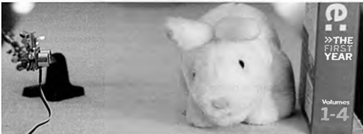
Figure 3.7 Test du capteur Ping avec un objet mou
